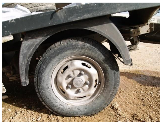
Σχήμα 35. FORD TRANSIT PICKUP, οπίσθιος αριστερός τροχός, καλή κατάσταση πέλματος ελαστικού, βύθιση του οπίσθιου ελαστικού στο 50% του ύψους της παρειάς κατά την πρόσπτωση του βυτιοφόρου.
