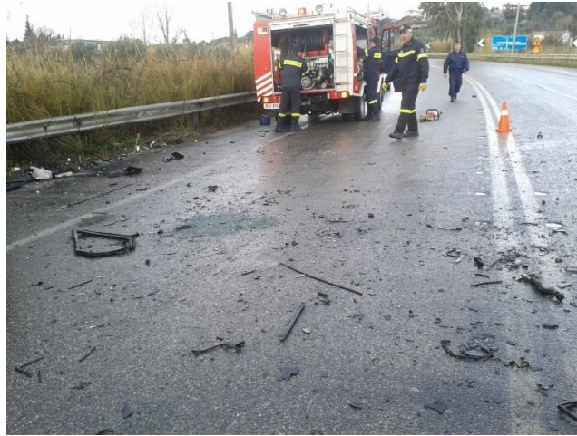
Σχήμα 4. Η σκηνή του ατυχήματος στη ΧΘ 21,850 Ν.Ε.Ο. Πατρών-Πύργου. Το ελαστικό στεγανωτικό πλαίσιο του σταθερού ανεμοθώρακα της θύρας οδηγού του FORD TRANSIT και θραύσματα γυαλιού του σταθερού ανεμοθώρακα στο οδόστρωμα.
