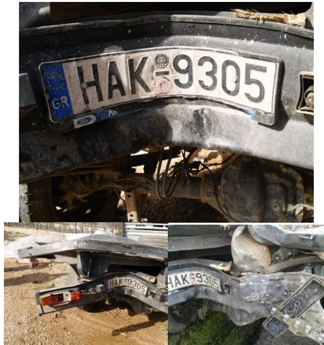
Σχήμα 81. Η οπίσθια επιφάνεια του FORD TRANSIT επί της οποίας επέπεσε ο αριστερός τροχός του πρώτου εκ των τριών αξόνων του επικαθημένου βυτιοφόρου.
