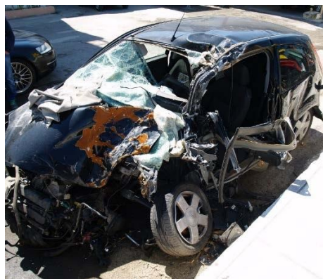
Σχήμα 19. FORD FIESTA, εμπρόσθια πλευρά, ο κινητήρας έχει μεταφερθεί εμπροσθεν του οχήματος, .
