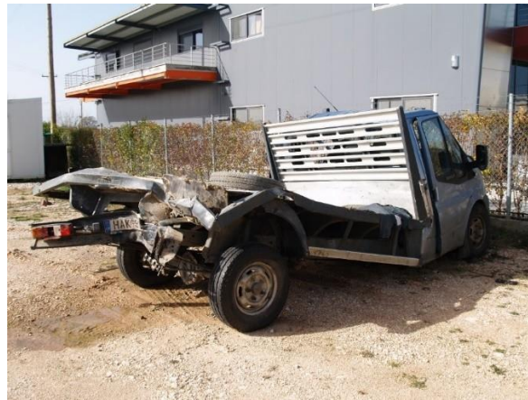
Σχήμα 36. FORD TRANSIT PICKUP, οπίσθια πλευρά, παραμόρφωση κατά την πρόσπτωση του βυτιοφόρου.
