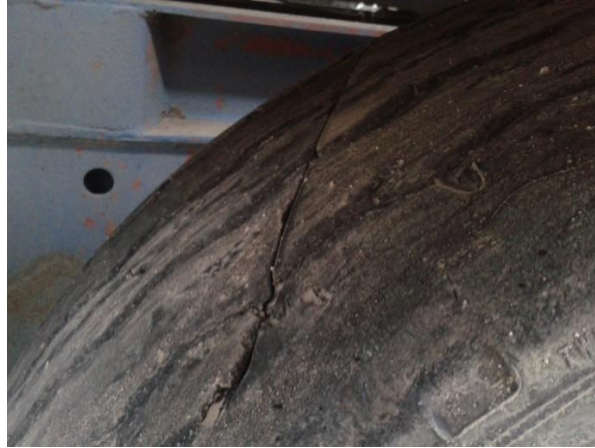
Σχήμα 55. Τριαξονικό επικαθήμενο ημιρυμουλκούμενο όχημα. Φθαρμένο ελαστικό στην αριστερή πλευρά, πρώτος άξονας, ελαστικό που ήρθε σε επαφή με το FORD TRANSIT.
