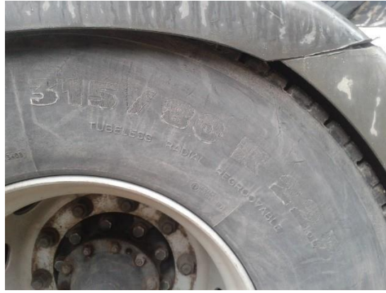
Σχήμα 41. Ο ελκυστήρας SCANIA. Οπίσθιο ελαστικό 315 80 R 22.5, αριστερή πλευρά.
