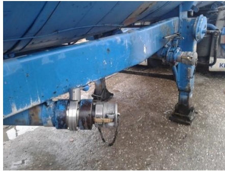
Σχήμα 49. Τριαξονικό επικαθήμενο ημιρυμουλκούμενο. Πόδες στηρίξεως, ελλιπής πλευρική προστασία.
