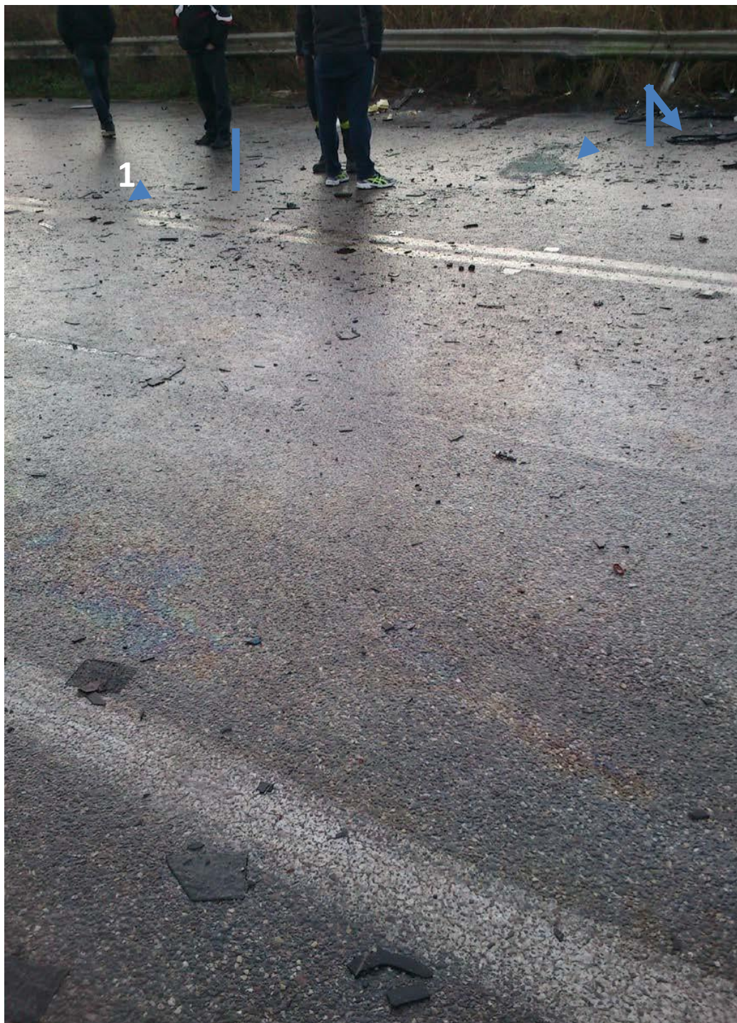
Σχήμα 79. Θραύσματα του σταθερού ανεμοθώρακα της θύρας οδηγού του FORD TRANSIT και του στεγανωτικού παρεμβύσματος στο ρεύμα κυκλοφορίας Πύργος – Πάτρα (άνω δεξιά) που επιβεβαιώνουν τη σύγκρουση με το Ford Fiesta παρά τη διπλή διαχωριστική γραμμή και πλησίον του σημείου αναφοράς «1».
