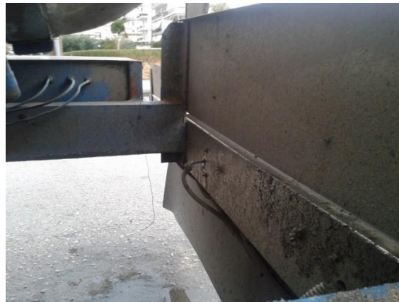
Σχήμα 53. Τριαξονικό επικαθήμενο ημιρυμουλκούμενο όχημα. Ανεπαρκής εγκατάσταση ηλεκτρικών γραμμών φωτισμού πίσω δεξιά.
