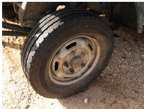
Σχήμα 37. FORD TRANSIT PICKUP, οπίσθιος δεξιός τροχός, βύθιση του οπίσθιου ελαστικού στο 90% του ύψους της παρειάς κατά την πρόσπτωση του βυτιοφόρου.
