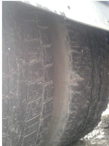
Σχήμα 42. Ελκυστήρας Δημοσίας Χρήσεως ΕΚΒ 1167, επιθεώρηση της 30ης/1/2015. Διαφορετικοί τύποι φθαρμένων ελαστικών εσωτερικά εξωτερικά στους τροχούς αριστερά στονοπίσθιο άξονα του ελκυστήρα.
