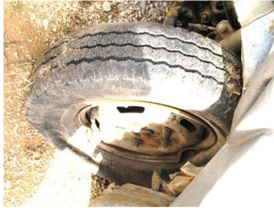
Σχήμα 33. FORD TRANSIT PICKUP, εμπρόσθιος αριστερός τροχός με πλήρη απώλεια πίεσης, ασφαλικό υλικό μεταξύ σώτρου και ελαστικού επισώτρου, καλή κατάσταση πέλματος ελαστικού.
