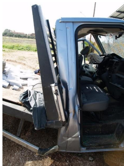
Σχήμα 82. Παραμόρφωση του θαλάμου επιβατών του FORD TRANSIT εκ της συγκρούσεως με το επικαθημένο βυτιοφόρο.
