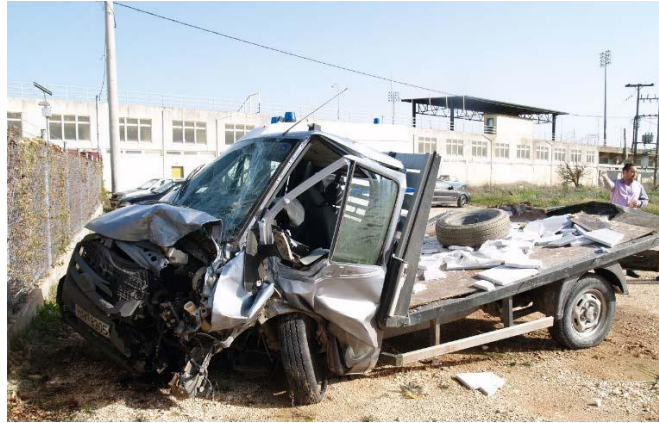
Σχήμα 31. FORD TRANSIT PICKUP αριστερή πλευρά, ο πλευρικός σταθερός ανεμοθώρακας της θύρας οδηγού εκτινάχθηκε στο οδόστρωμα στη σκηνή του ατυχήματος.
