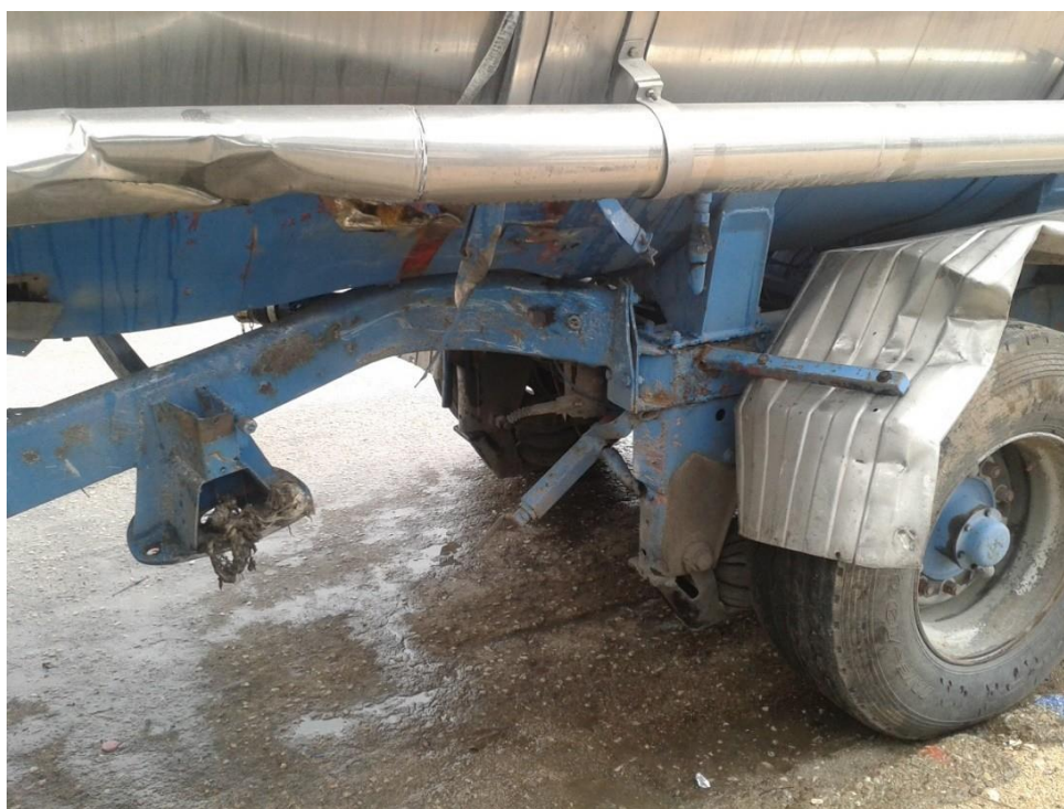
Σχήμα 80. Τριαξονικό επικαθήμενο ημιρυμουλκούμενο όχημα με αριθμό κυκλοφορίας Ρ- 20066 και αριθμό πλαισίου 53009380. Η αριστερή πλευρά και το σημείο σύγκρουσης με το FORD TRANSIT στον αριστερό τροχό του πρώτου εκ των τριών αξόνων του επικαθημένου βυτιοφόρου.
