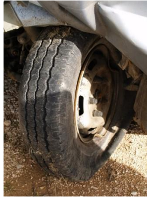
Σχήμα 77. Περιστροφή του εμπρόσθιου αριστερού τροχού του FORD TRANSIT κατά τη σύγκρουση που συνοδεύεται από πλήρη απώλεια πίεσεως του ελαστικού.
