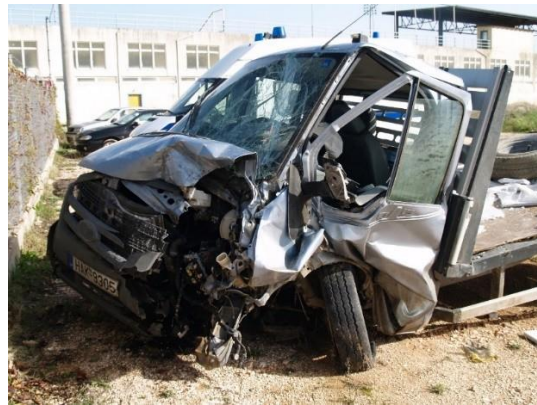
Σχήμα 32. FORD TRANSIT PICKUP, 30η/1/2015, το σημείο συγκρούσεως με το Ford Fiesta, η οριζόντια δοκός του πλαισίου (ράμφος) που εισχωρεί στο κιβώτιο ταχυτήτων του Ford Fiesta. Ο εμπρόσθιος αριστερός τροχός με πλήρη απώλεια πίεσεως.
