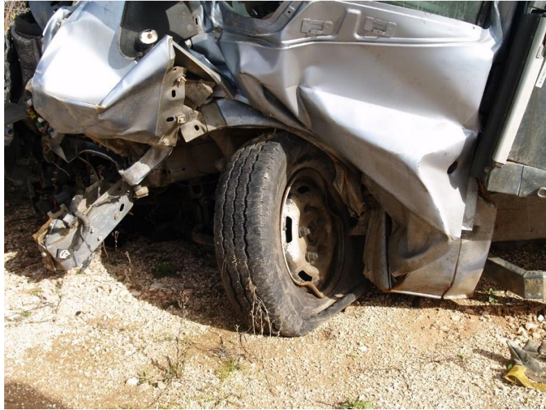
Σχήμα 72. Το FORD TRANSIT Εισχώρηση του ΕΑ τροχού του στον ΕΑ τροχό του οριζόντια δοκού του πλαισίου (ράμφος) του FORD TRANSIT που λειτούργησε ως εξολκείας για την εξάρμωση του συγκροτήματος κινητήρα – κιβωτίου ταχυτήτων του Ford Fiesta.
