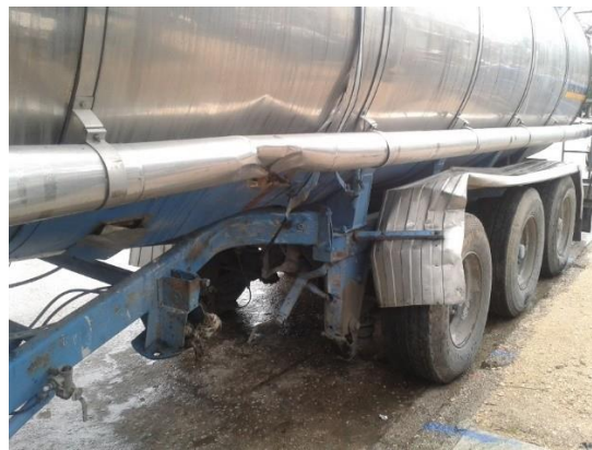
Σχήμα 45. Τριαξονικό επικαθήμενο ημιρυμουλκούμενο όχημα. Η αριστερή πλευρά και το σημείο σύγκρουσης με το FORD TRANSIT πριν το φορείο των τριών αξόνων του επικαθήμενου βυτιοφόρου. Εισχώρηση του FORD TRANSIT υπό γωνία 45°.
