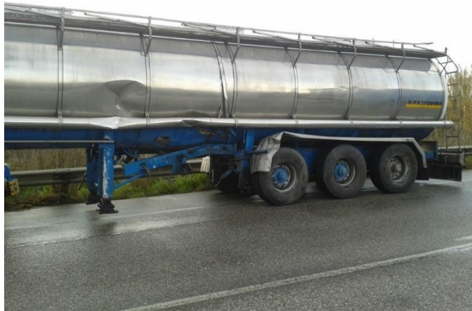
Σχήμα 44. Τριαξονικό επικαθήμενο ημιρυμουλκούμενο. Η αριστερή πλευρά και το σημείο σύγκρουσης με το FORD TRANSIT επί των ποδών στηρίξεως και πριν το φορείο των τριών αξόνων του επικαθήμενου βυτιοφόρου.
