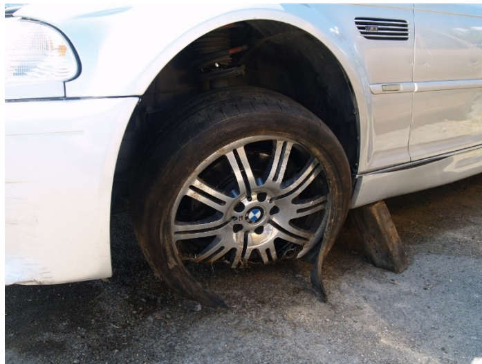
Σχήμα 28. BMW M3 επιβατικό όχημα, ο εμπρόσθιος αριστερός τροχός που συγκρούστηκε με το ρείθρο του πεζοδρομίου.
