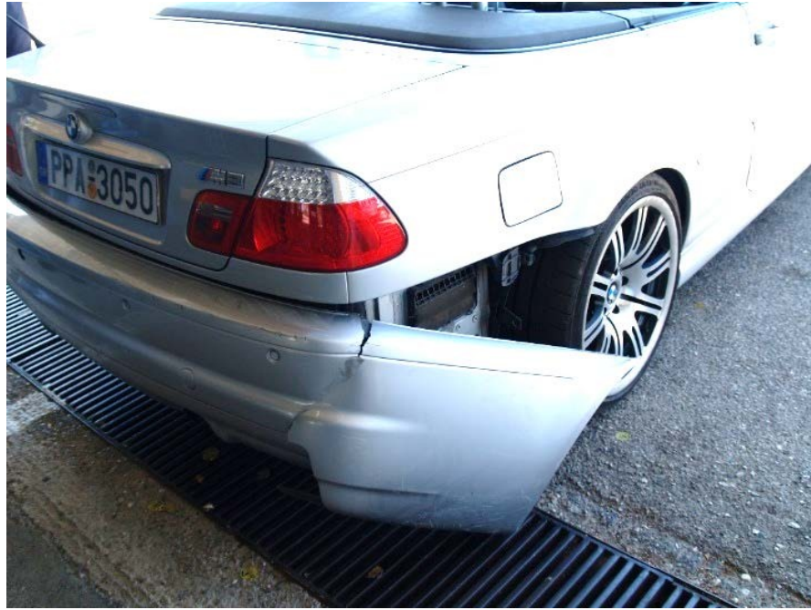
Σχήμα 44. BMW M3 επιβατικό όχημα, η οπίσθια πλευρά, ο προφυλακτήρας αποκολλήθηκε κατά τη σύγκρουση από την αριστερή πλευρά.
