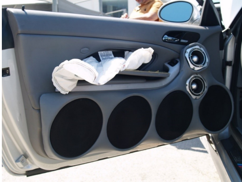
Σχήμα 38. Ενεργοποίηση του πλευρικού αερόσακου της θύρας οδηγού, υπερμεγέθη ηχεία στις θύρες οδηγού και συνοδηγού.
