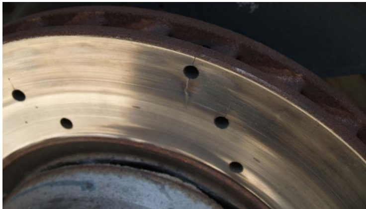
Σχήμα 74. BMW M3 επιβατικό όχημα, ο εμπρόσθιος αριστερός ο δίσκος πέδησης, ρωγμές παρά τις οπές εξαερισμού των δίσκων τριβής του συστήματος πέδησης εμπρός παραπέμπουν σε σκληρή χρήση του συστήματος πεδήσεως.
