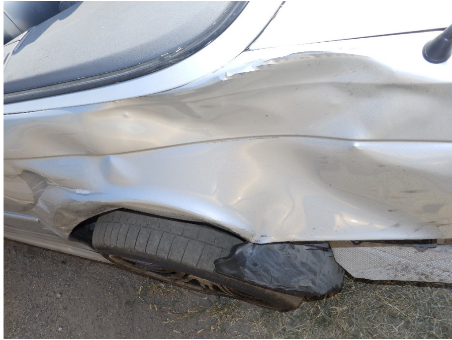
Σχήμα 49. Το οπίσθιο αριστερό τμήμα του αμαξώματος που συγκρούστηκε με την πεζή και το παιδικό αμαξίδιο, απόκλιση του οπίσθιου αριστερού τροχού από την παραμόρφωση της συνδετήριας ράβδου με το πλαίσιο.
