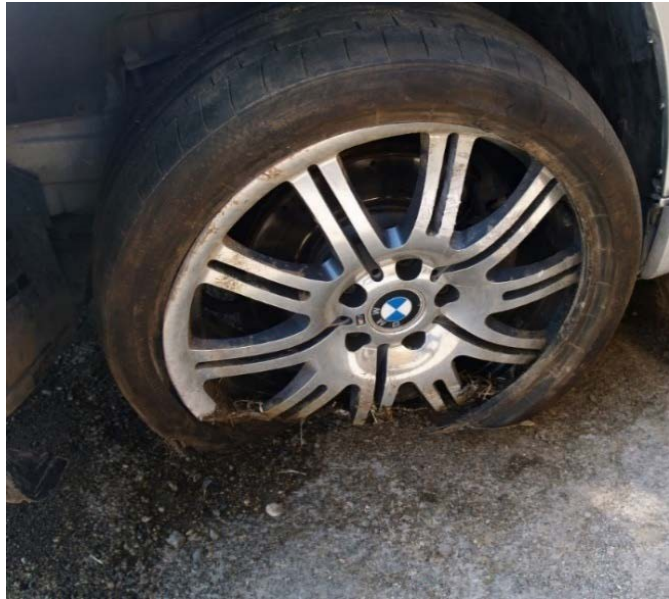
Σχήμα 63. BMW M3 επιβατικό όχημα, ο εμπρόσθιος αριστερός τροχός, δέκα δίδυμες ακτίνες, τρεις ακτίνες έχουν υποστεί θραύση και πλαστική παραμόρφωση.
