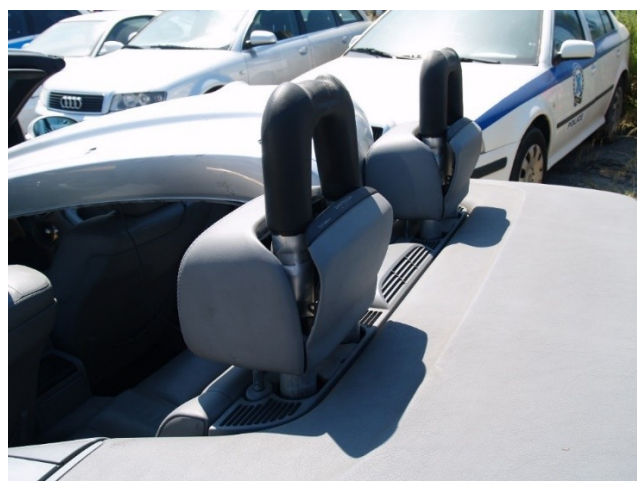
Σχήμα 37. BMW M3 επιβατικό όχημα, ενεργοποίηση των δοκών προστασίας ανατροπής.
