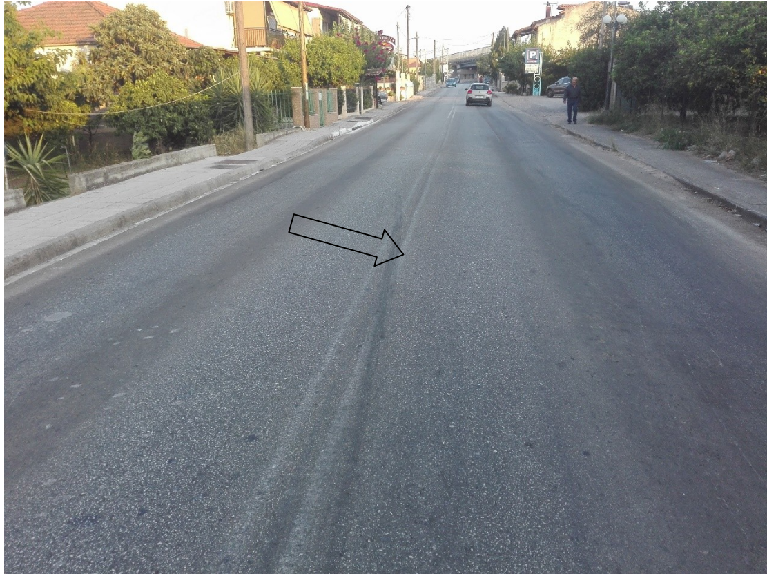
Σχήμα 21. Τελευταία στάδιο της πορείας του BMW M3. Το ίχνος του εμπρόσθιου αριστερού τροχού υπερκαλύπτεται από ίχνος πέδησης του αριστερού οπίσθιου τροχού. Παρατηρητής με μέτωπο προς ανατολάς, στο βάθος ο ανισόπεδος κόμβος με τη Ν.Ε.Ο. Πατρών-Αθηνών.
