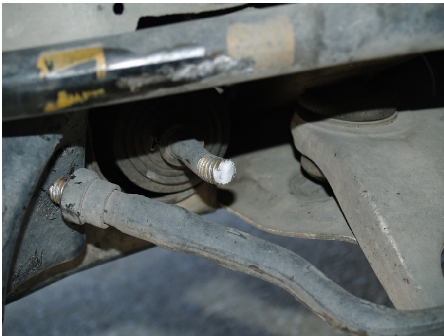
Σχήμα 70. BMW M3 επιβατικό όχημα, ο εμπρόσθιος αριστερός τροχός, ο βραχίονας του συστήματος διεύθυνσεως έχει υποστεί θραύση από λυγισμό στην περιοχή του σπειρώματος όπου και υψηλότερη συγκέντρωση τάσεων.
