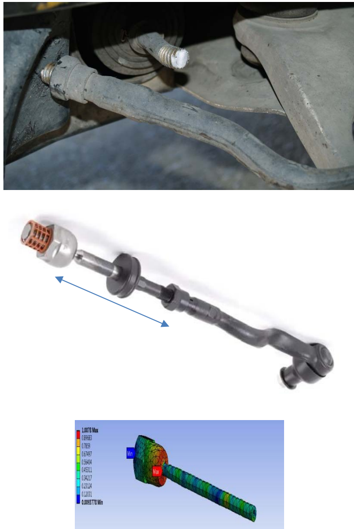
Σχήμα 90. BMW M3 επιβατικό όχημα, άνω: ο εσωτερικός βραχίονας ελέγχου του συστήματος διεύθυνσεως αριστερά έχει υποστεί θραύση από λυγισμό, μέσο: ο πλήρης βραχίονας ελέγχου, κάτω ο εσωτερικός βραχίονας μήκους 120 χιλ.
