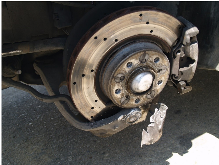
Σχήμα 66. BMW M3 επιβατικό όχημα, θήκη του εδράνου κυλίσεως του τροχού, ο δίσκος πέδησης που έσπασε από την αντίδραση του κάτω βραχίονα της ανάρτησης που παραμορφώθηκε στο άκρο.
