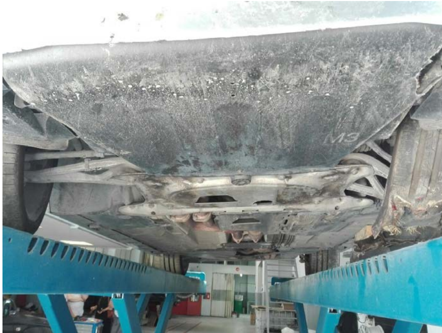
Σχήμα 51 BMW M3 επιβατικό όχημα στο εμπρόσθιο μέρος, διακρίνεται η παραμόρφωση της ανάρτησης του εμπρόσθιου αριστερού τροχού, η υποχώρηση του τροχού προς το διαμήκη άξονα του οχήματος μετρήθηκε 150 χιλ.
