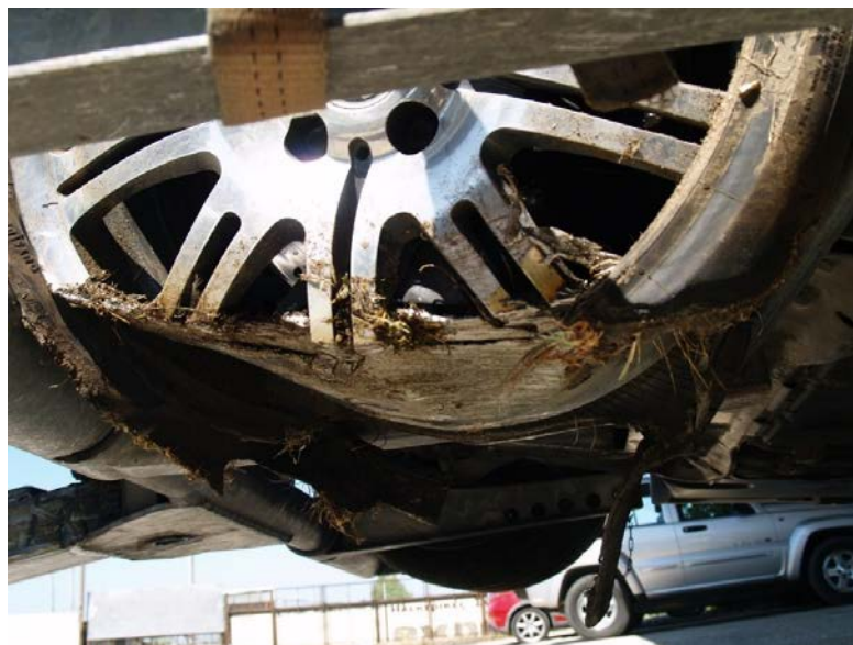
Σχήμα 88. PPA-3050 (EIX) BMW M3, τρεις ακτίνες και το κάτω μέρος της στεφάνης του εμπρόσθιου αριστερού τροχού που συγκρούστηκε με το ρείθρο του πεζοδρομίου.
