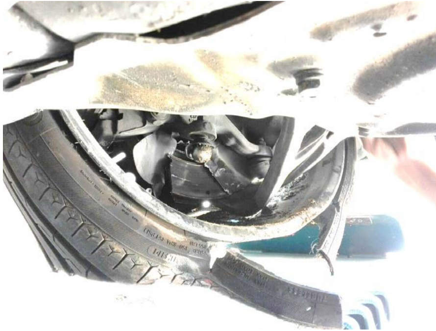
Σχήμα 67. BMW M3 επιβατικό όχημα, ο εμπρόσθιος αριστερός τροχός εσωτερικά, ο δίσκος πέδησης που έσπασε από την αντίδραση του κάτω βραχίονα της ανάρτησης που παραμορφώθηκε και ο σφαιρικός σύνδεσμος του κάτω βραχίονα που υπέστη εξάρμωση και παρέμεινε στη θήκη του εδράνου κυλίσεως(ακραξόνιο).
