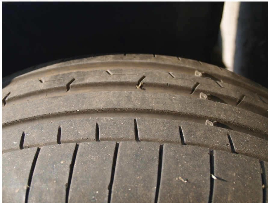
Σχήμα 59. BMW M3 επιβατικό όχημα, ο εμπρόσθιος δεξιός τροχός, ελαστικό σε καλή κατάσταση
