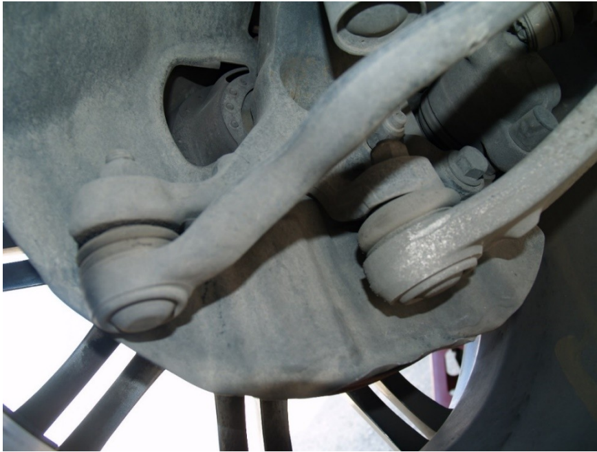
Σχήμα 73. BMW M3 επιβατικό όχημα, ο εμπρόσθιος δεξιός τροχός εσωτερικά, αριστερά ο βραχίονας του συστήματος διευσθύνσεως με το σφαιρικό σύνδεσμο στο άκρο προς τον τροχό, δεξιά ο κάτω βραχίονας της ανάρτησης και ο σφαιρικός σύνδεσμος του κάτω βραχίονα με το ακραζόνιο.
