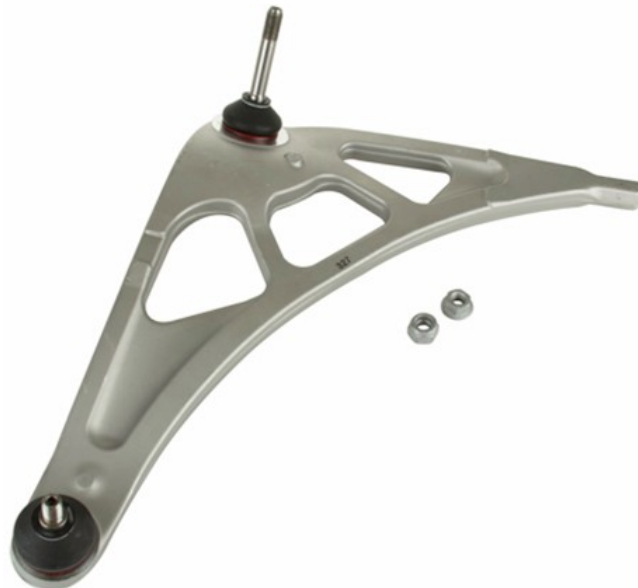
Σχήμα 68. BMW M3 επιβατικό όχημα, άθικτος ο κάτω βραχίονας της ανάρτησης και ο σφαιρικός σύνδεσμος επί του βραχίονα.
