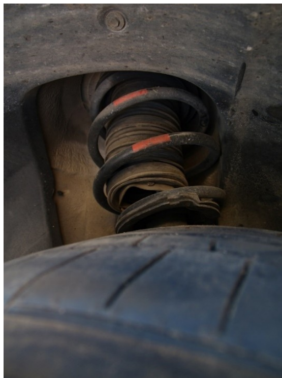
Σχήμα 64. BMW M3 επιβατικό όχημα, ο εμπρόσθιος αριστερός τροχός, ο κατακόρυφος βραχίον αναρτήσεως (McPherson strut) που έχει υποστεί πλαστική παραμόρφωση κατά τη σύγκρουση του τροχού με το πεζοδρόμιο.
