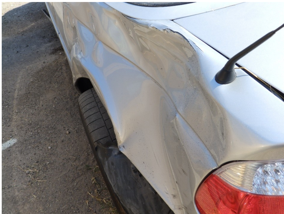
Σχήμα 48. Το οπίσθιο αριστερό τμήμα του αμαξώματος που συγκρούστηκε με την πεζή και το παιδικό αμαξίδιο, παραμόρφωση της ανάρτησης του οπίσθιου αριστερού τροχού.
