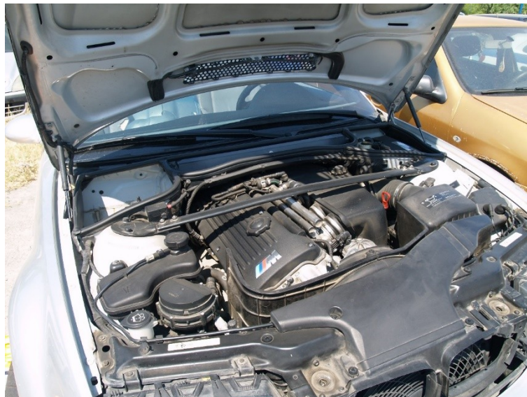
Σχήμα 32. BMW M3 επιβατικό όχημα, κινητήρας εξακύλινδρος εν σειρά.
