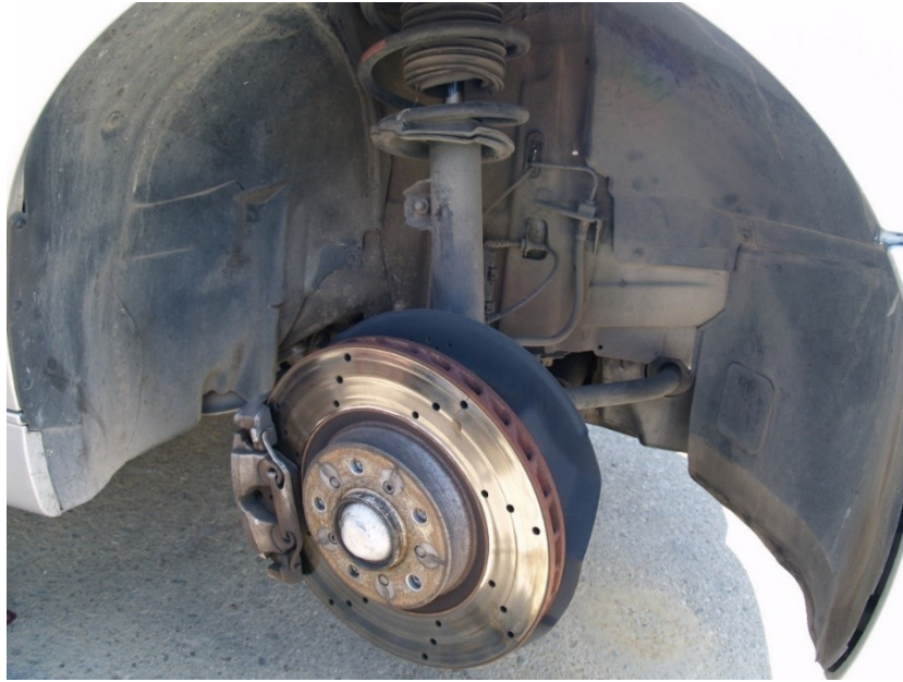
Σχήμα 71. BMW M3 επιβατικό όχημα, ο εμπρόσθιος δεξιός τροχός, ο κατακόρυφος βραχίων αναρτήσεως (McPherson strut) η θήκη του εδράνου κυλίσεως του τροχού, η σιαγόνα πέδησης και ο δίσκος πέδησης.
