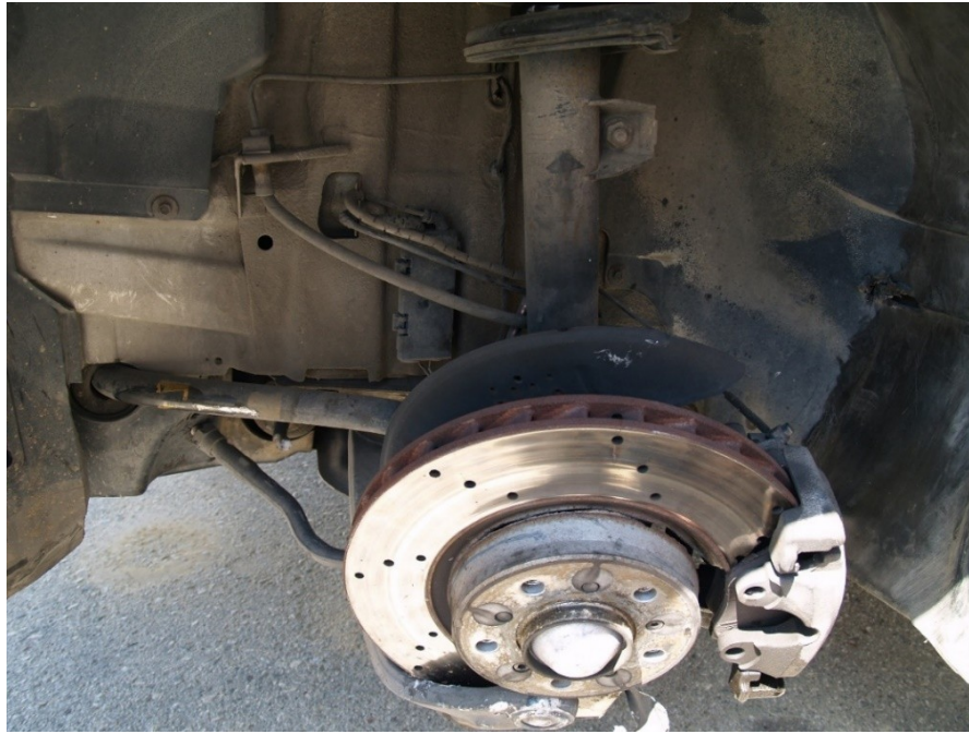
Σχήμα 65. BMW M3 επιβατικό όχημα, ο εμπρόσθιος αριστερός τροχός, ο κατακόρυφος βραχίον αναρτήσεως (McPherson strut) η θήκη του εδράνου κυλίσεως του τροχού, ο δίσκος πέδησης που έσπασε από την αντίδραση του κάτω βραχίονα της ανάρτησης που παραμορφώθηκε από λυγισμό.
