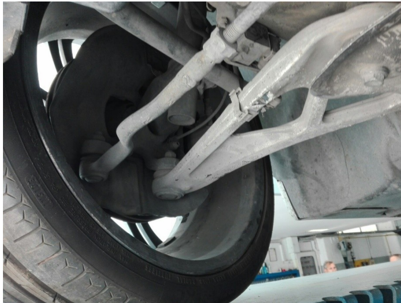
Σχήμα 72. BMW M3 επιβατικό όχημα, ο εμπρόσθιος δεξιός τροχός εσωτερικά, ο κάτω βραχίονας της ανάρτησης και ο σφαιρικός σύνδεσμος του κάτω βραχίονα που με τη θήκη του εδράνου κυλίσεως (ακραζόνιο) και ο βραχίονας του συστήματος διεύθυνσεως με το σφαιρικό σύνδεσμο στο άκρο προς τον τροχό.
