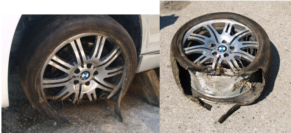
Σχήμα 54. BMW M3 επιβατικό όχημα, ο εμπρόσθιος αριστερός τροχός, δέκα δίδυμες ακτίνες, τρεις ακτίνες με θραύση και πλαστική παραμόρφωση.
