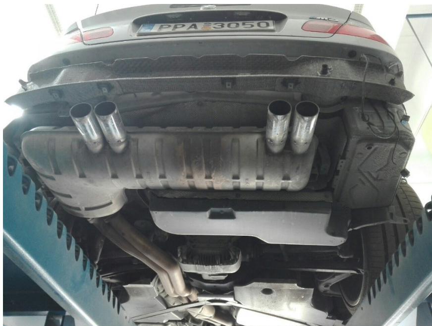
Σχήμα 52 BMW M3 επιβατικό όχημα, το οπίσθιο μέρος, διακρίνεται το σύστημα εξαγωγής καυσαερίων.
