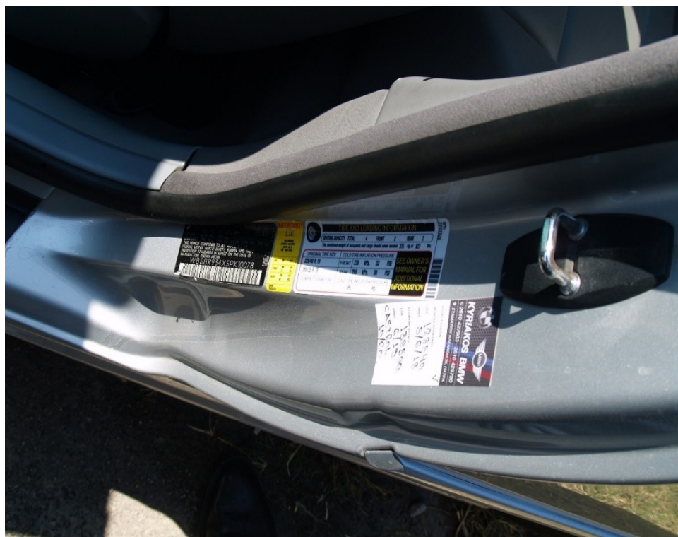
Σχήμα 53. BMW M3 επιβατικό όχημα, πινακίδιο στη θύρα οδηγού: αριθμός παλίσιου, η συμφωνία με τις Ευρωπαϊκές και Ομοσπονδιακές προδιαγραφές ασφαλείας που ίσχυαν κατά την ημερομηνία παραγωγής, ο επιτρεπόμενος αριθμός επιβατών εμπρός – πίσω, διαστάσεις και πιέσεις ελαστικών.
