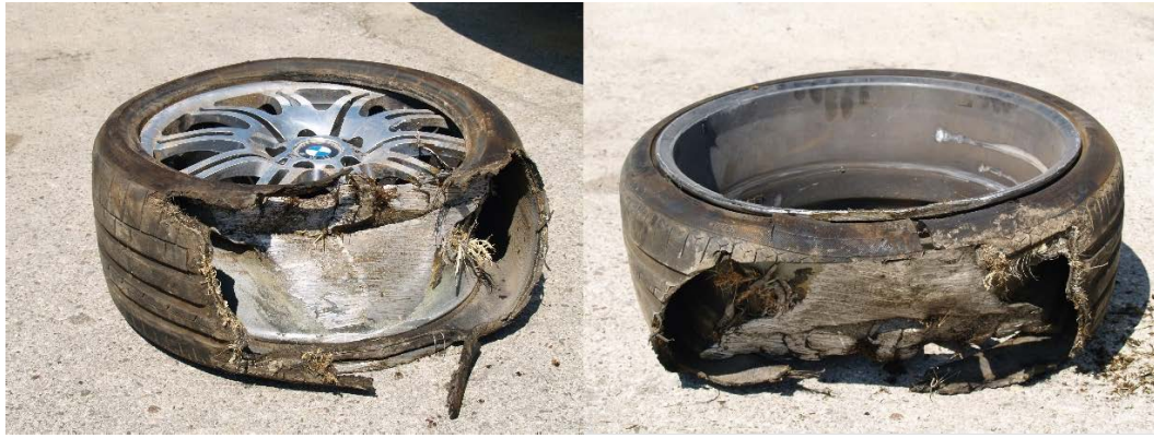
Σχήμα 56. BMW M3 επιβατικό όχημα, ο εμπρόσθιος αριστερός τροχός, η επιφάνεια επαφής της στεφάνης με το οδόστρωμα.
