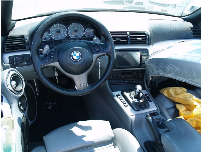
Σχήμα 33. Η θέση οδήγησης του επιβατικού οχήματος BMW M3, τα χειριστήρια αλλαγής ταχυτήτων στο πηδάλιο διεύθυνσεως και ο πίναξ οργάνων.
