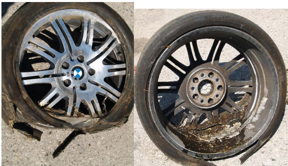
Σχήμα 55. BMW M3 επιβατικό όχημα, ο εμπρόσθιος αριστερός τροχός, εξωτερική και εσωτερική πλευρά, απώλεια υγρών φρένων κατά τη σύγκρουση και η ταυτόχρονη ακινητοποίηση του τροχού.
