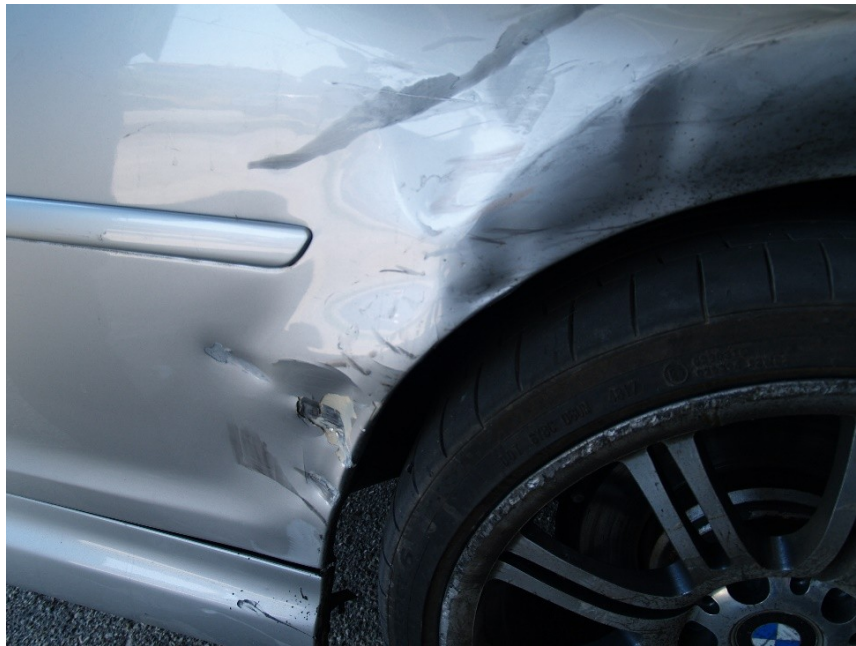
Σχήμα 50. Το οπίσθιο αριστερό τμήμα του αμαξώματος που συγκρούστηκε με το παιδικό αμαξίδιο.
