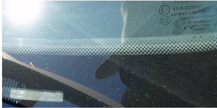
Σχήμα 31. Ο αριθμός πλαισίου του BMW M3-Series E46 WBSBR934X5PK10078 σε ειδικό άνοιγμα του εμπρόσθιου ανεμοθώρακα.
