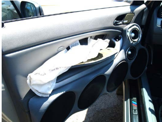
Σχήμα 36. Ενεργοποίηση του αερόσακου της θύρας οδηγού υποδηλώνει πλευρική σύγκρουση στην αριστερή πλευρά.
