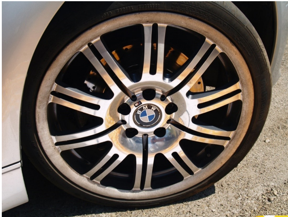
Σχήμα 57. BMW M3 επιβατικό όχημα, ο εμπρόσθιος δεξιός τροχός, 10 ακτίνες, διαστάσεις 235/35 ZR19 αντί του προβλεπομένου 225/40 R19, ημερομηνία παραγωγής 37η εβδομάδα 2018.
