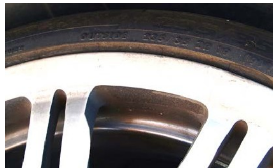
Σχήμα 61. BMW M3 επιβατικό όχημα, ο εμπρόσθιος δεξιός τροχός, ελαστικό κατασκευής 37 ης εβδομάδας 2018, 235/35 ZR19 αντί του προβλεπομένου 225/40 R19.
