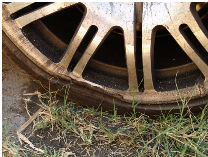
Σχήμα 62. BMW M3 επιβατικό όχημα, οπίσθιος αριστερός τροχός, ρωγμή κατά την ανάβαση στο ρεϊθρο του πεζοδρομίου, ίχνη ιστών και υφάσματος από τη σύγκρουση με την πεζή.
