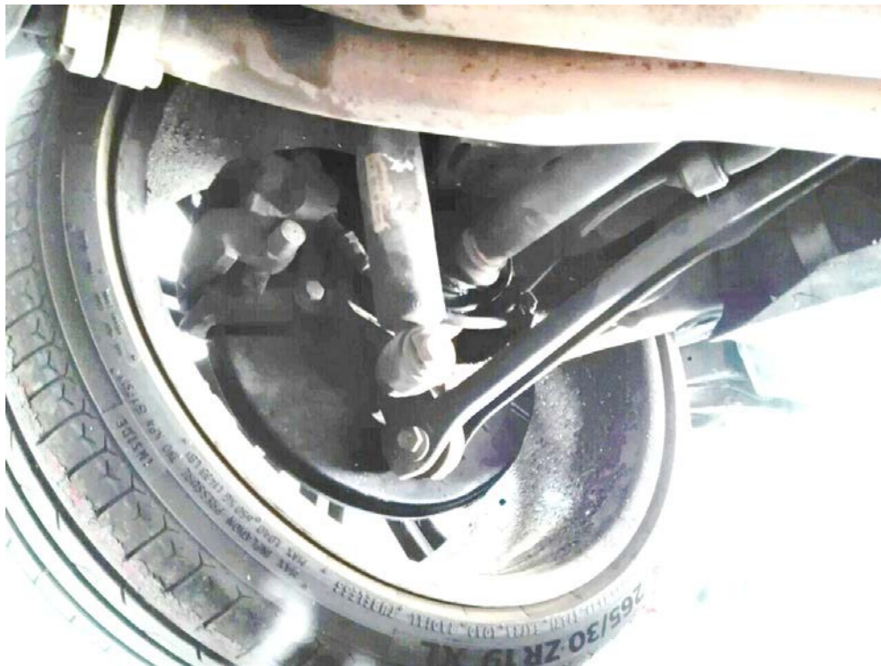
Σχήμα 76. BMW M3 επιβατικό όχημα, ο οπίσθιος αριστερός τροχός, παραμόρφωσ του κάτω βραχίονα ανάρτησης.
