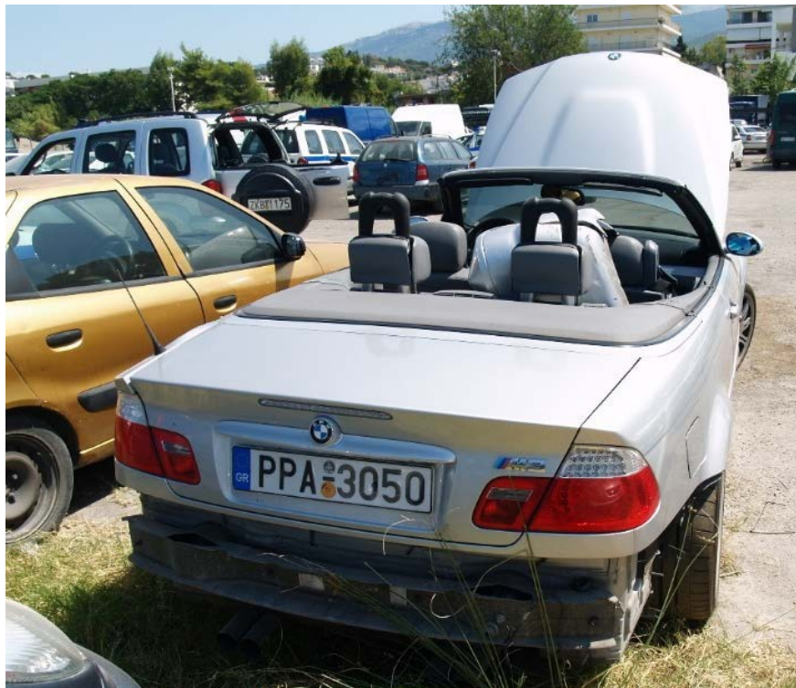
Σχήμα 43. BMW M3 επιβατικό όχημα, η οπίσθια πλευρά, επανέλεγχος ΚΤΕΟ 10/2019, ο προφυλακτήρας αποκολλήθηκε κατά τη σύγκρουση, αναδυόμενες δοκοί από τα οπίσθια προσκέφαλα για προστασία ανατροπής σε συνδυασμό με το πλαίσιο ανεμοθώρακα.
