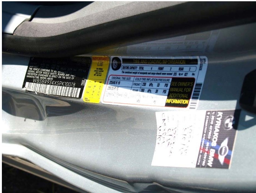
Σχήμα 25. BMW M3, το όχημα πληροί όλες τις Ευρωπαϊκές και Ομοσπονδιακές προδιαγραφές ασφαλείας που ίσχυαν κατά την ημερομηνία παραγωγής, τύπος και πιέσεις ελαστικών εμπρός-πίσω 225/40 R19 και 255/40 R19.
