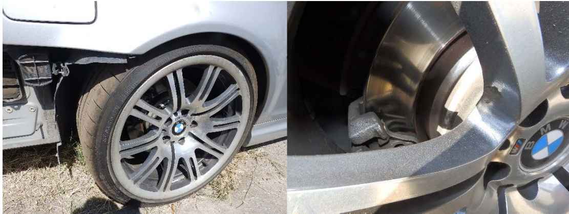
Σχήμα 60. BMW M3 επιβατικό όχημα, οπίσθιος δεξιός τροχός, ελαστικό κατασκευής 1 ης εβδομάδας 2018, σύστημα πέδησης σε καλή κατάσταση, διάσταση ελαστικού 265/30 ZR19 αντί της προβλεπόμενης 255/35 R19.
