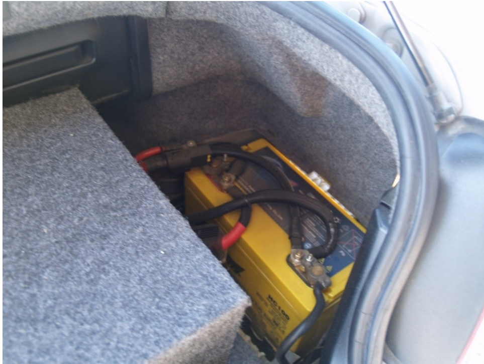
Σχήμα 40. Διάταξη εγκατάστασης ηχείων χαμηλών συχνοτήτων στο χώρο αποσκευών και ο συσσωρευτής χωρίς προστατευτικό κάλυμμα
