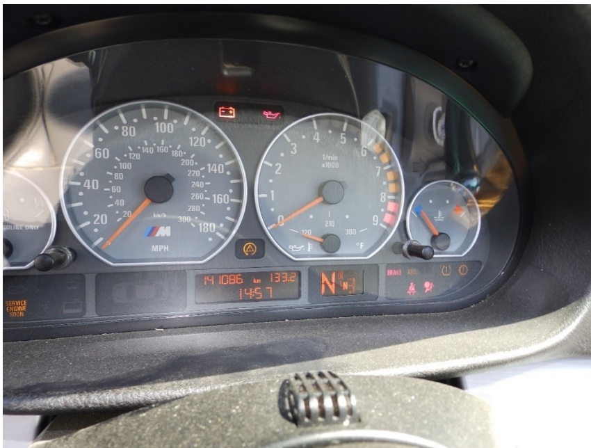
Σχήμα 34. Ο πίναξ οργάνων. Ένδειξη οδομέτρου 141.860 χλμ., βλάβες συστημάτων ABS, ESP, ανακλινόμενης οροφής, αερόσακκων, δοκών προστασίας ανατροπής.
