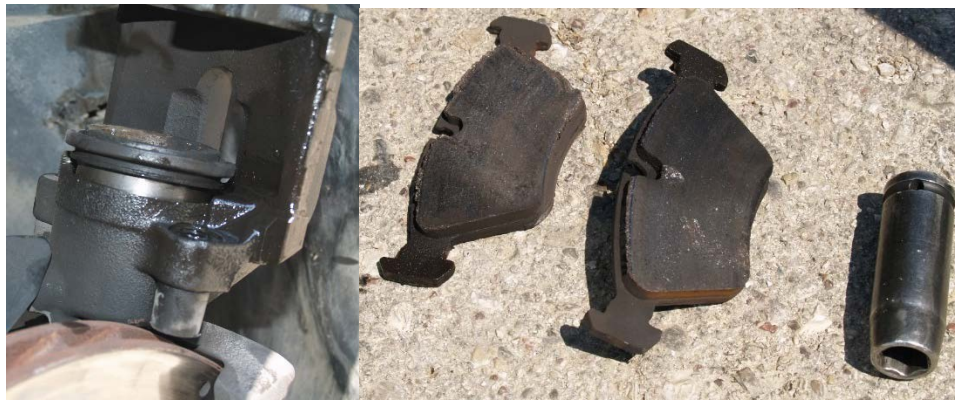
Σχήμα 75. Το έμβολο πίεσεως και οι επιφάνειες τριβής που έχουν διαβραχεί από ταυδραυλικό έλαιο του κυκλώματος πεδήσεως που διέρρευσε κατά τη σύγκρουση.
