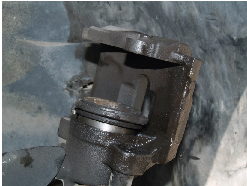
Σχήμα 69. BMW M3 επιβατικό όχημα, ο εμπρόσθιος αριστερός τροχός, η σιαγόνα του συστήματος πέδησης και η απώλεια υδραυλικού ελαίου εκ της θραύσεως του δίσκου πέδησης.
