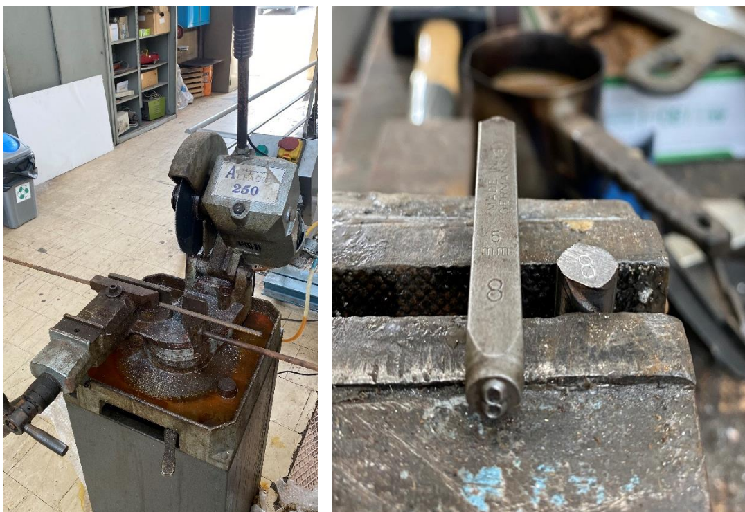
Εικόνα 4-1: α) Διαδικασία κοπής και β) πονταρίσματος των δοκιμίων.
