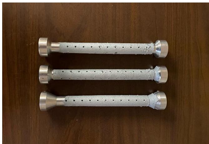
Εικόνα 4-2: Τα καλούπια που χρησιμοποιήθηκαν στην μερική επικάλυψη δοκιμίων.
