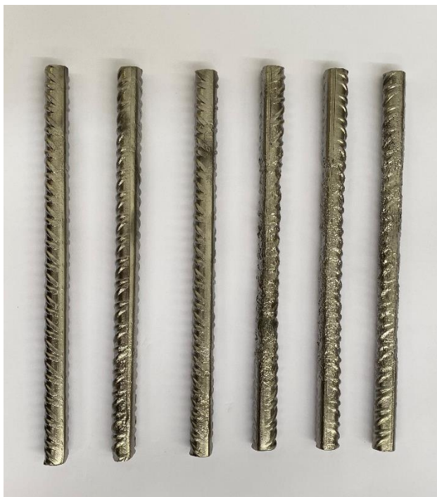
Εικόνα 4-7: Οι ράβδοι μετά τον καθαρισμό με τη βούρτσα.
