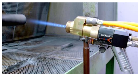
Εικόνα 3-4: Σχηματισμός shock diamonds στον πίδακα φλόγας.
