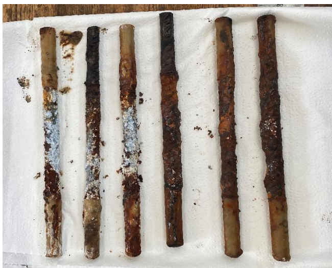
Εικόνα 4-6: Πλήρως και μερικώς επικαλυμμένες, διαβρωμένες ράβδοι πριν καθαριστούν με τη βούρτσα.
