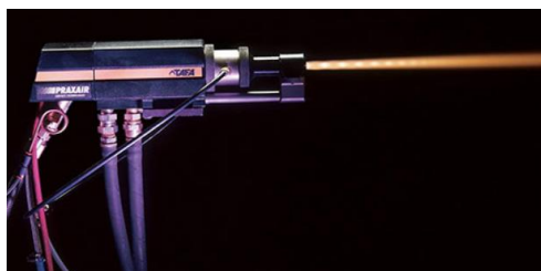
Εικόνα 3-4: Σχηματισμός shock diamonds στον πίδακα φλόγας.
