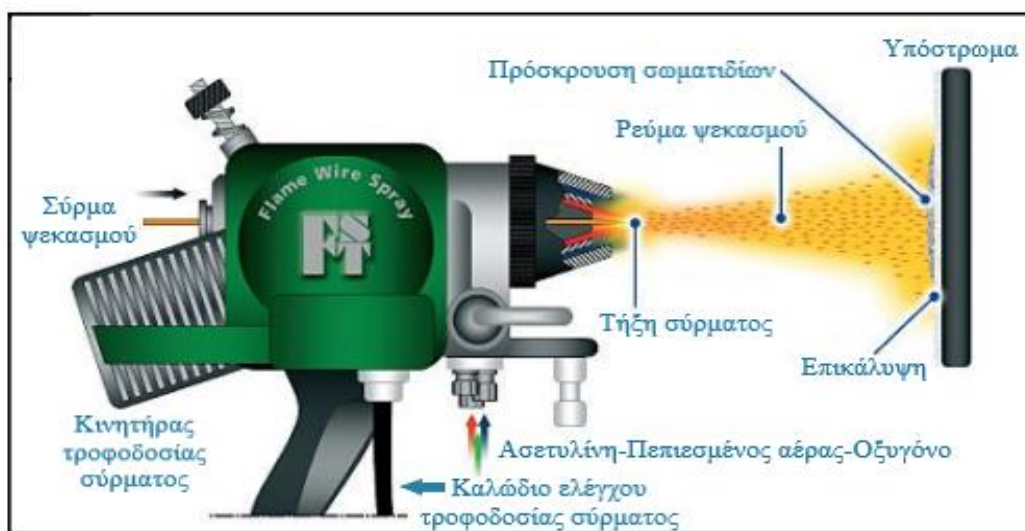
Σχήμα 3-6: Ψεκασμός σύρματος με φλόγα [14].
