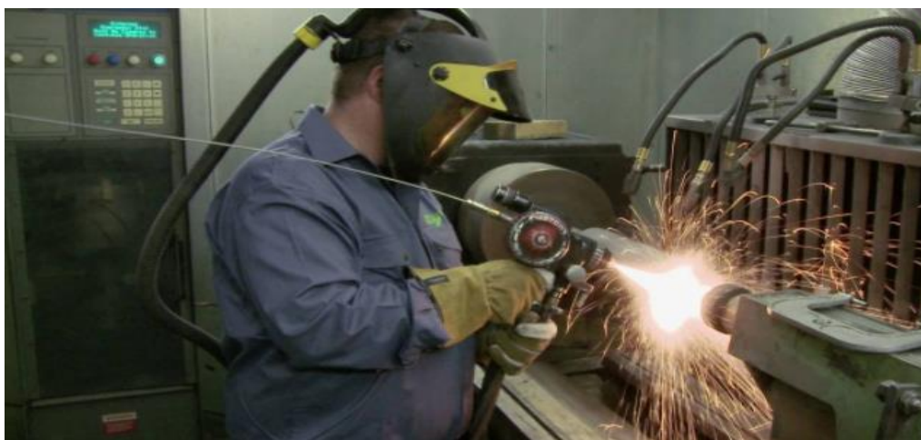
Εικόνα 3-3 : Χειροκίνητη διαδικασία ψεκασμού με φλόγα.
