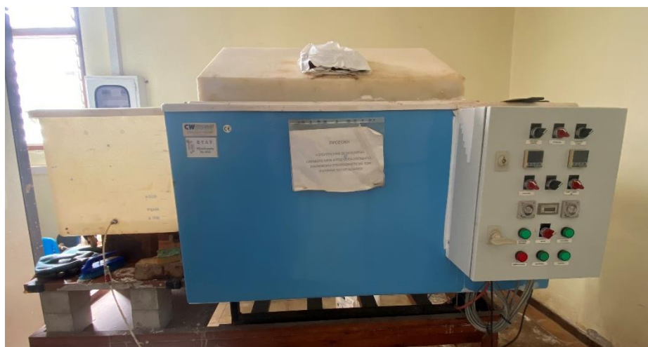
Εικόνα 4-3: Η διάταξη επιταχυνόμενης διάβρωσης αλατονέφωσης του εργαστηρίου.
