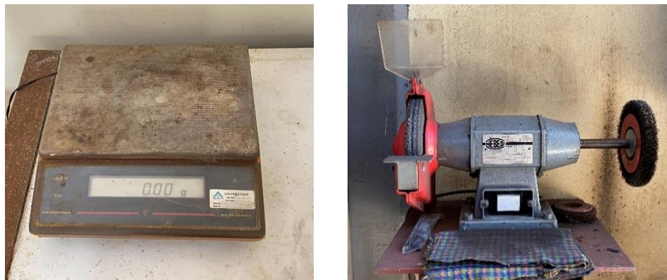
Εικόνα 4-5: α) Η ζυγαριά και β) η βούρτσα που χρησιμοποιήθηκαν για το ζύγισμα και τον καθαρισμό των δοκιμίων.
