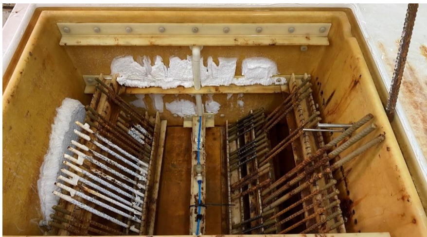
Εικόνα 4-4: Το εσωτερικό του θαλάμου αλατονέφωσης με τα δοκίμια.
