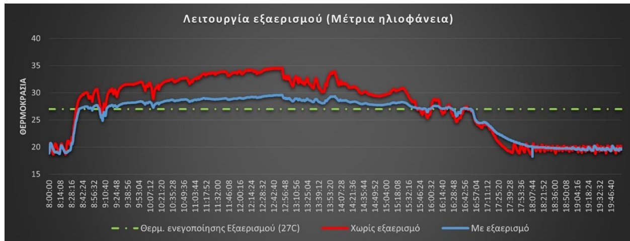
Εικόνα 5.9. Λειτουργία εξαερισμού σε ημέρα με μέτρια ηλιοφάνεια
