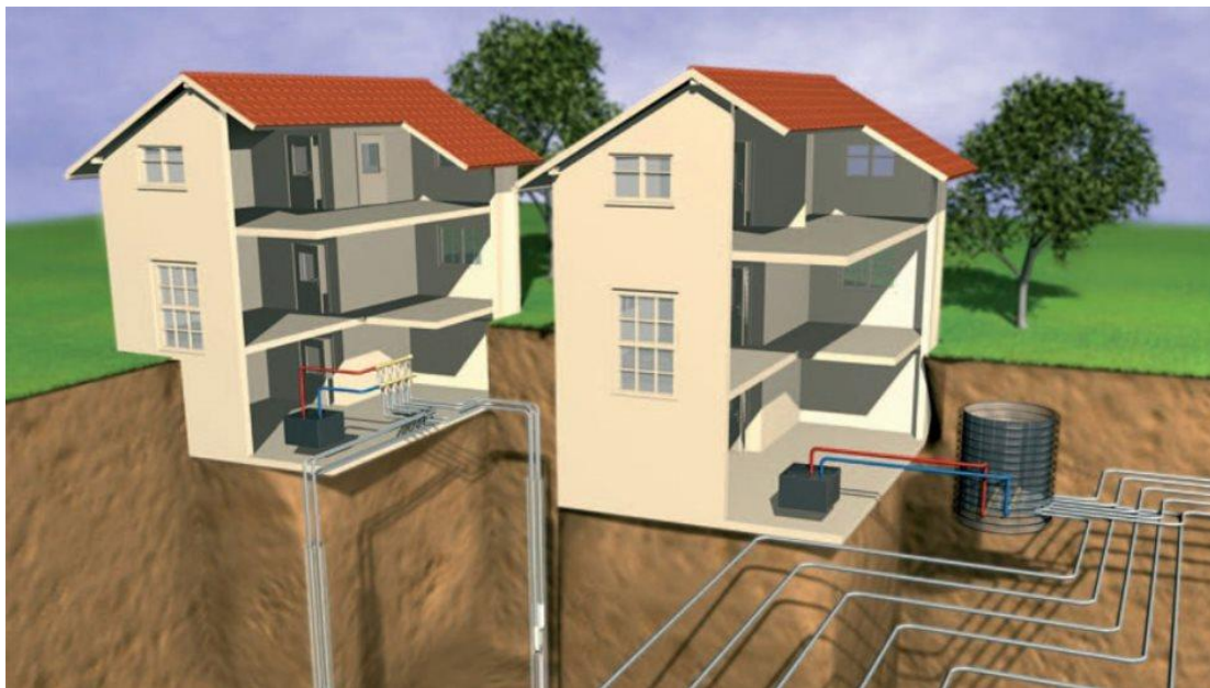
Εικόνα 2.6. Γεωθερμικό σύστημα θέρμανσης/ψύξης κτηρίου ( https://www.protothema.gr/ )
