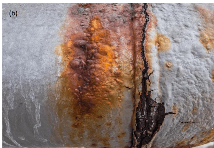
Σχήμα 1.12 Διάβρωση με μηχανική καταπόνηση (a) στο μικροσκοπικό επίπεδο (b) σε υπόγειο αγωγό.
