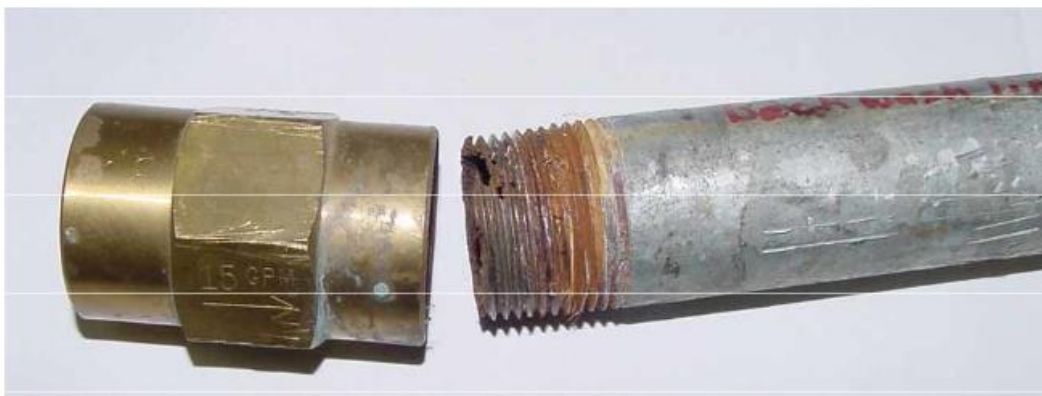
Σχήμα 1.5 Γαλβανική διάβρωση στις σπειρώσεις του χαλύβδινου σωλήνα στην συνδεσμολογία με ορειχάλκινο εξάρτημα.
