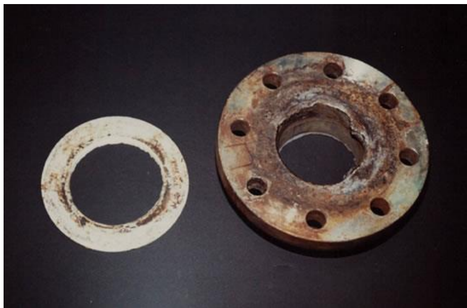
Σχήμα 1.6 Διάβρωση των κοιλοτήτων σε φλάντζα από ανοξείδωτο χάλυβα από περιβάλλον εμπλουτισμένο σε χλώριο.
