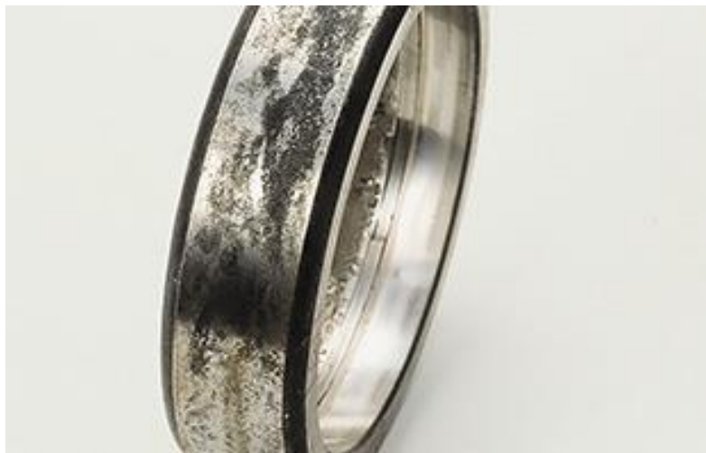
Σχήμα 1.8 Εξωτερικός δακτύλιος κυλινδρικού ρουλεμάν που έχει υποστεί διάβρωση παλινδρόμησης.
