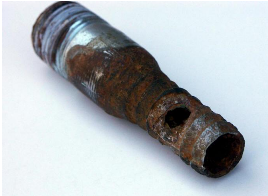
Σχήμα 1.6 Ρευστομηχανική διάβρωση σε εξάρτημα μηχανής πλύσης.
