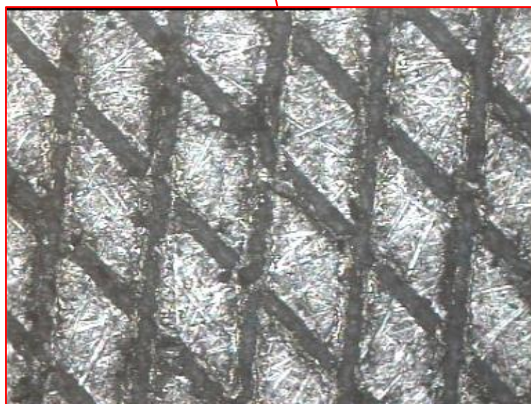
Εικόνα 58 Παρατήρηση της περιοχής συγκόλλησης Al-Glass με οπτικό μικροσκόπιο.
