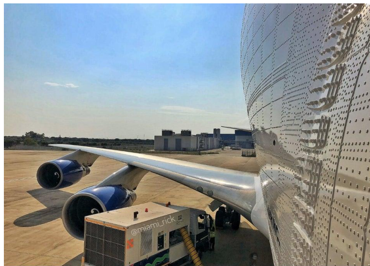
Εικόνα 3: Ηλώσεις σε τμήμα αεροσκάφους τύπου 747 Dreamlifter
