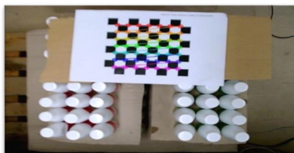
Εικόνα 2: Τεχνική καλιμπραρίσματος κάμερας μέσω της βιβλιοθήκης OpenCV
