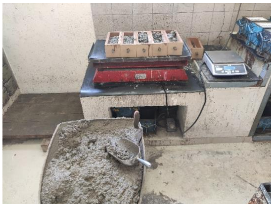
Εικόνα 3.2.3.(δ) : Διαδικασία τοποθέτησης σκυροδέματος στην ξύλινη μήτρα
