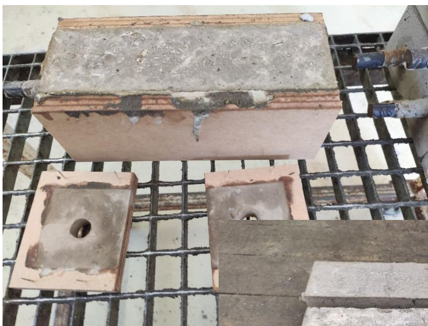
Εικόνα 3.2.3.(δ) : Διαδικασία τοποθέτησης σκυροδέματος στην ξύλινη μήτρα
