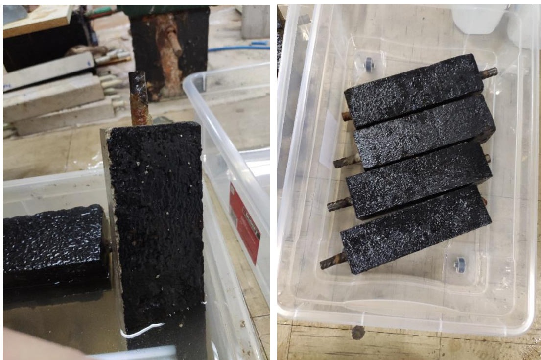
Εικόνα 3.3.2.(α) : Προετοιμασία Επιβολής Ηλεκτρικού Ρεύματος – Μόνωση Δοκιμών
