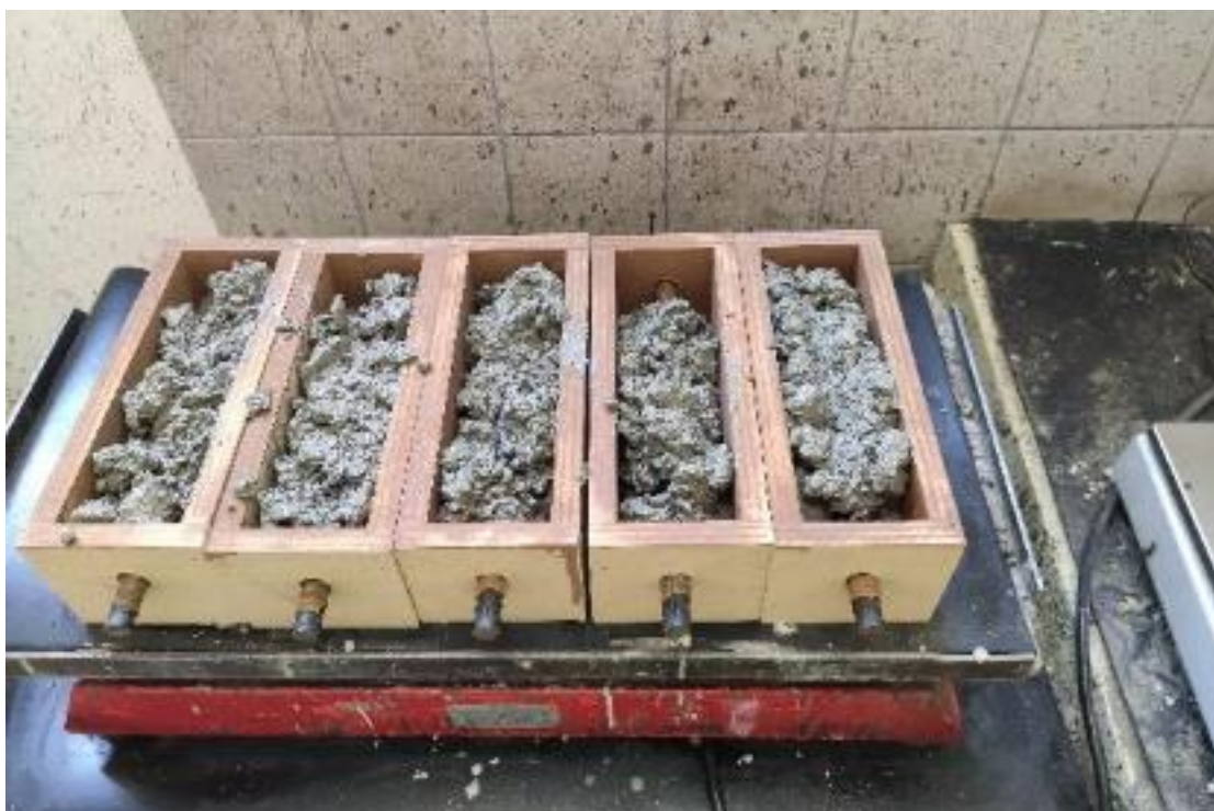
Εικόνα 3.2.3.(β) : Τοποθέτηση σκυροδετημένων δοκιμίων σε «δονητή» για ομοιόμορφη κατανομή του σκυροδέματος εντός της μήτρας
