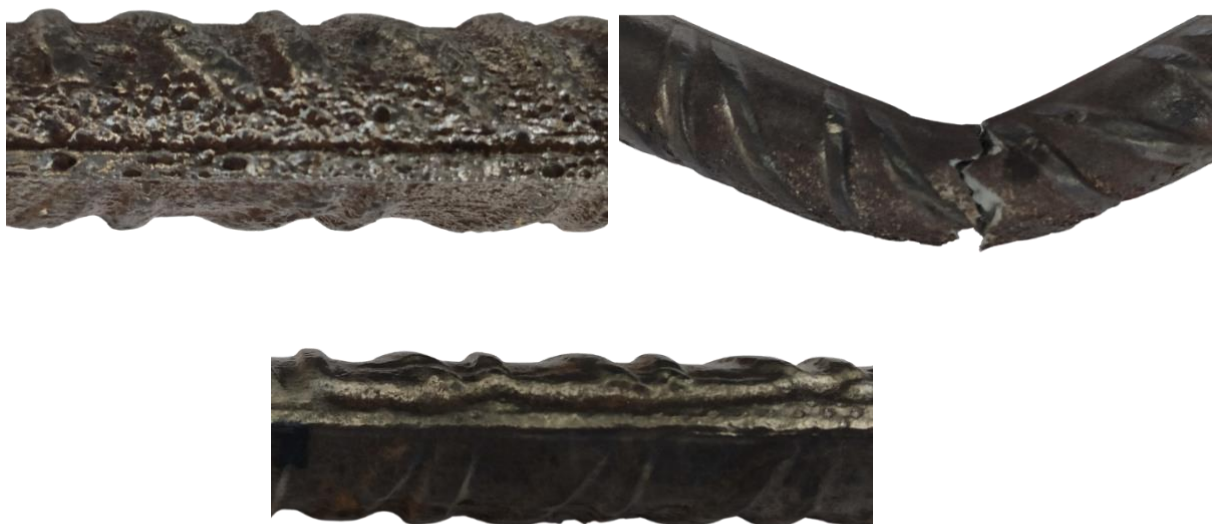
Εικόνα 5(η): Δοκίμια με ομοιόμορφη διάβρωση Steel 22-24-25
