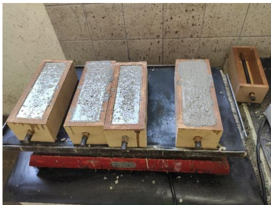
Εικόνα 3.2.3.(δ) : Διαδικασία τοποθέτησης σκυροδέματος στην ξύλινη μήτρα
