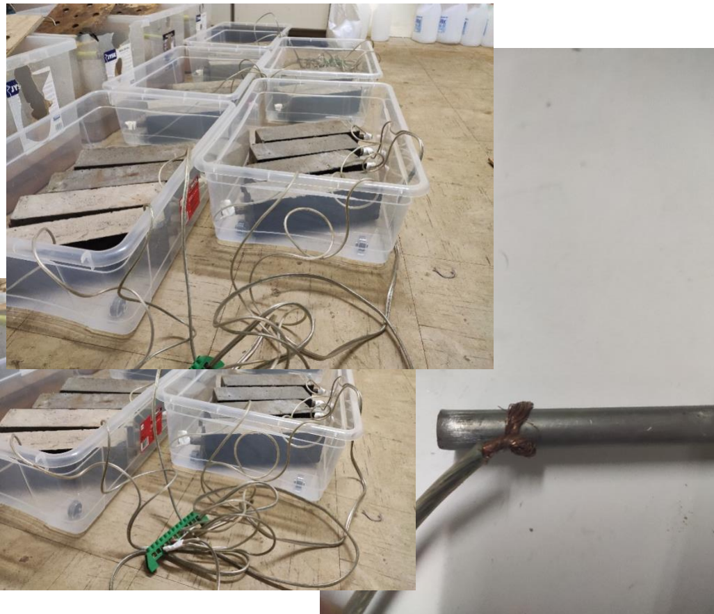
Εικόνα 3.3.2.(β) : Προετοιμασία Επιβολής Ηλεκτρικού Ρεύματος - Συνδεσμολογία
