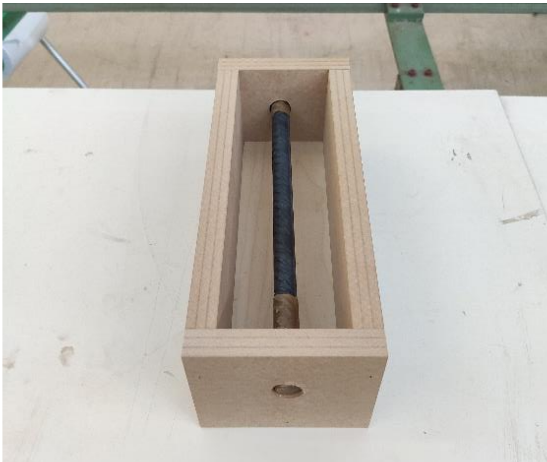
Εικόνα 3.2.3.(α) : Ξύλινη μήτρα και έκκεντρη τοποθέτηση δοκιμίου χάλυβα B500c πριν την σκυροδέτησή του
