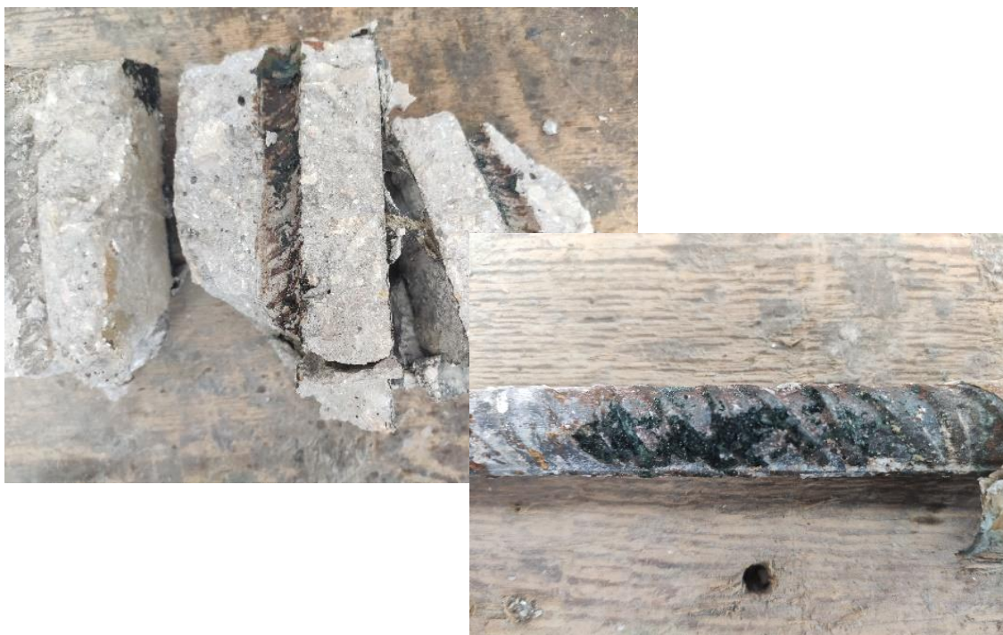
Εικόνα 3.4.(α) : Αφαίρεση χαλύβδινου οπλισμού από το δοκίμιο Ο/Σ
