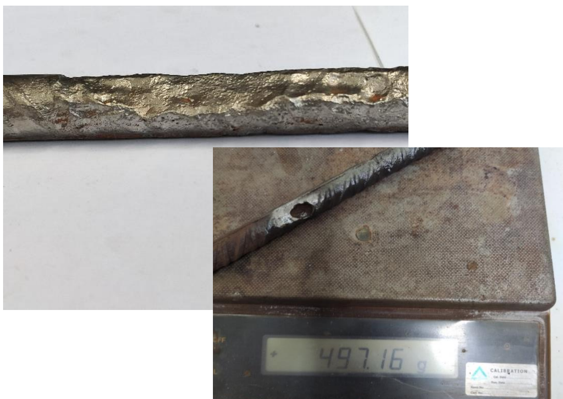
Εικόνα 3.4.(α) : Αφαίρεση χαλύβδινου οπλισμού από το δοκίμιο Ο/Σ
