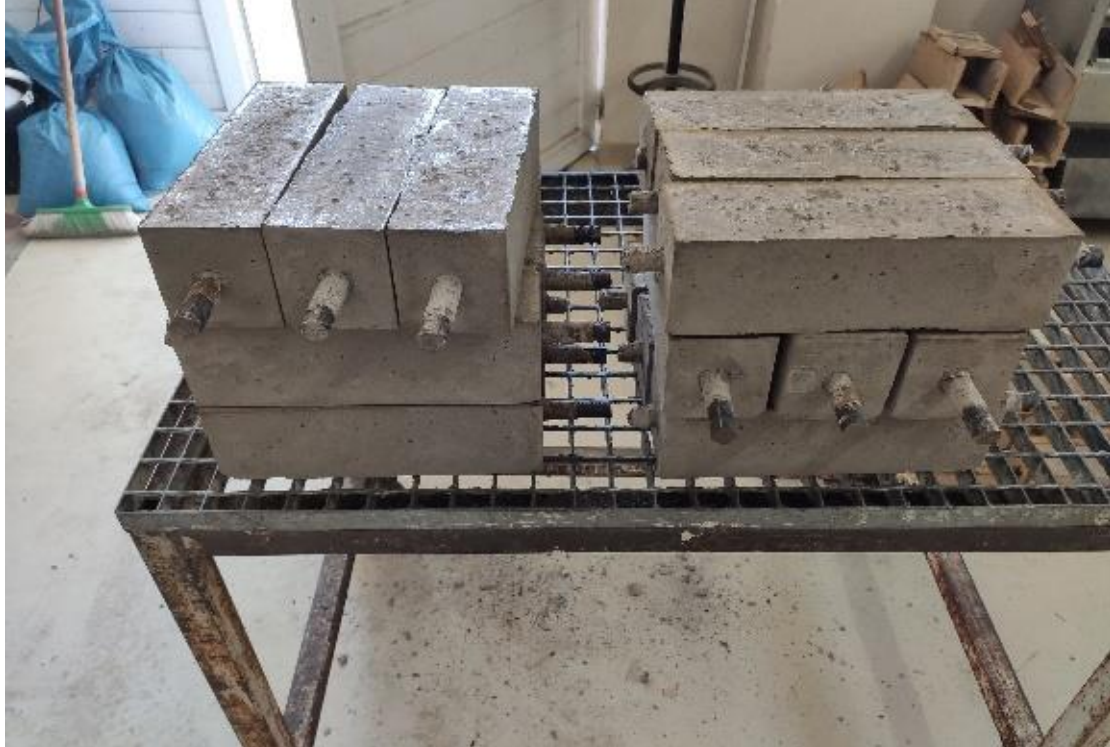
Εικόνα 3.2.3.(ε) : Αφαίρεση δοκιμίων σπλισμένου σκυροδέματος από τις ξύλινες μήτρες
