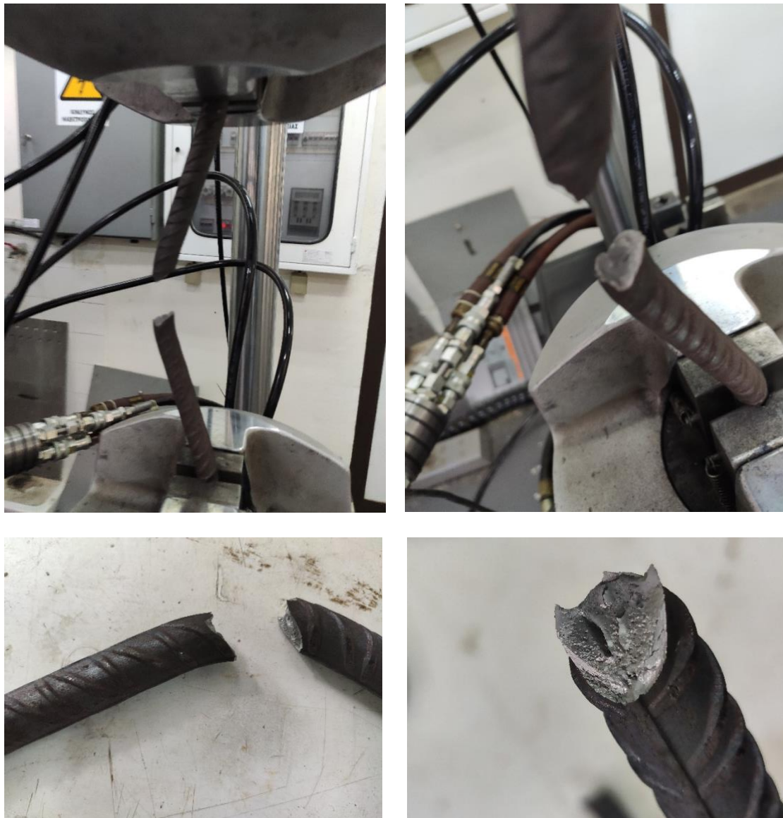
Εικόνες 3.6.(α): Μηχανική δοκιμή κόπωσης σε δοκίμιο αναφοράς (μη διαβρωμένο)
