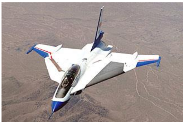
Εικόνα 31: Πειραματικό αεροσκάφος F-16XL με πορώδους επιφάνεια για τον έλεγχο του οριακού στρώματος[10].
