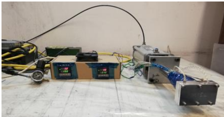
Figure 32: Εργαστηριακή διάταξη για την κατασκευή δοκιμίων μέσω της εξώθησης σε καλούπι
