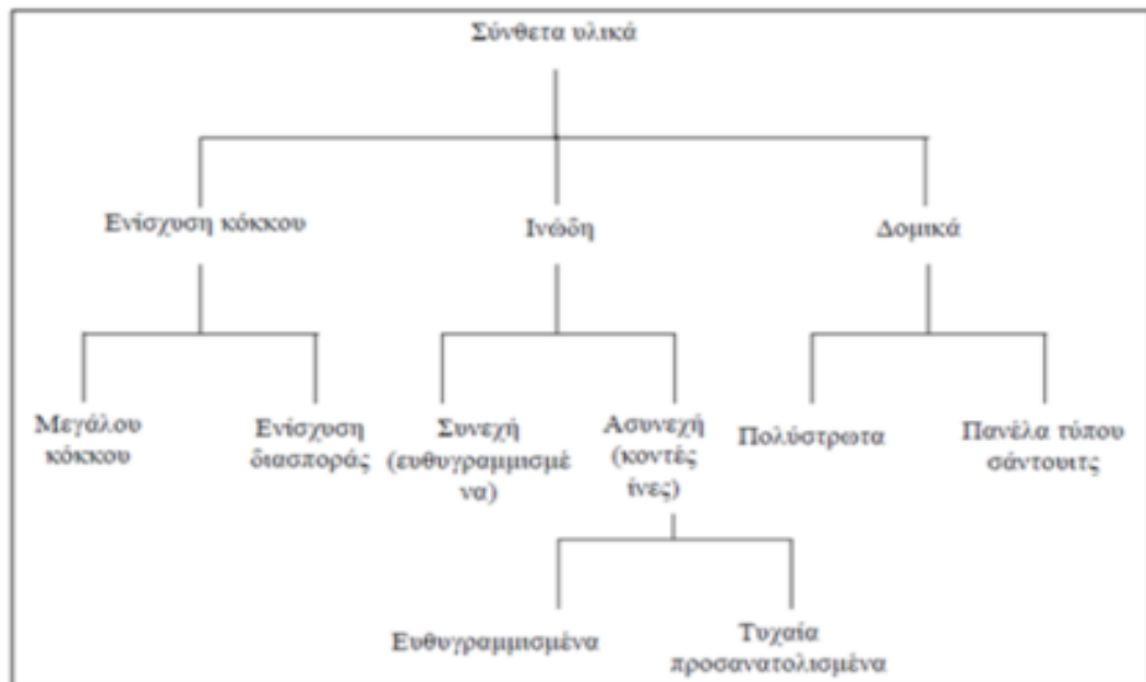
Figure 8: Ταξινόμηση σύνθετων υλικών βάσει της ενίσχυσης φάσης
