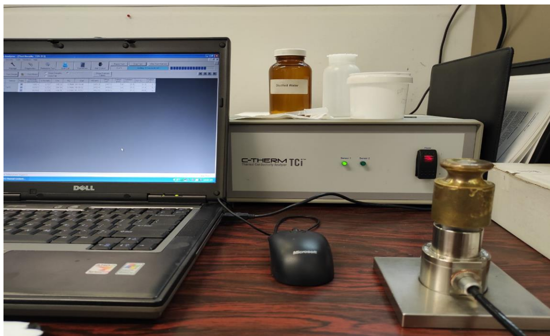
Figure 40 : Διάταξη μέτρησης θερμικής αγωγιμότητας Mathis Tci μέσω μεθόδου transient plane source
