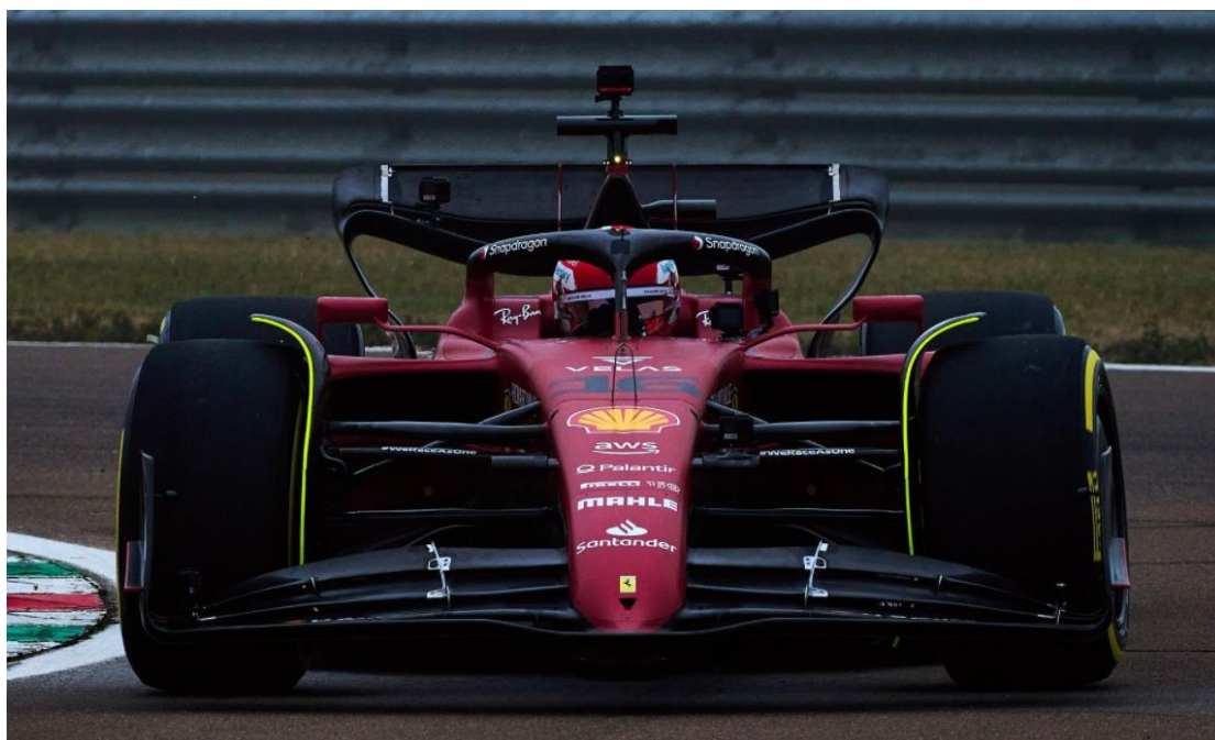
Εικόνα 1.14: Μονοθέσιο της F1 αποτελούμενο ως επί των πλείστων από σύνθετα υλικά με ανθρακονήματα.
