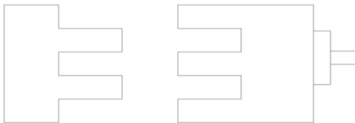
Εικόνα 2 Συμπλέκτης Τύπου Θετικού σε αποσύμπλεξη
