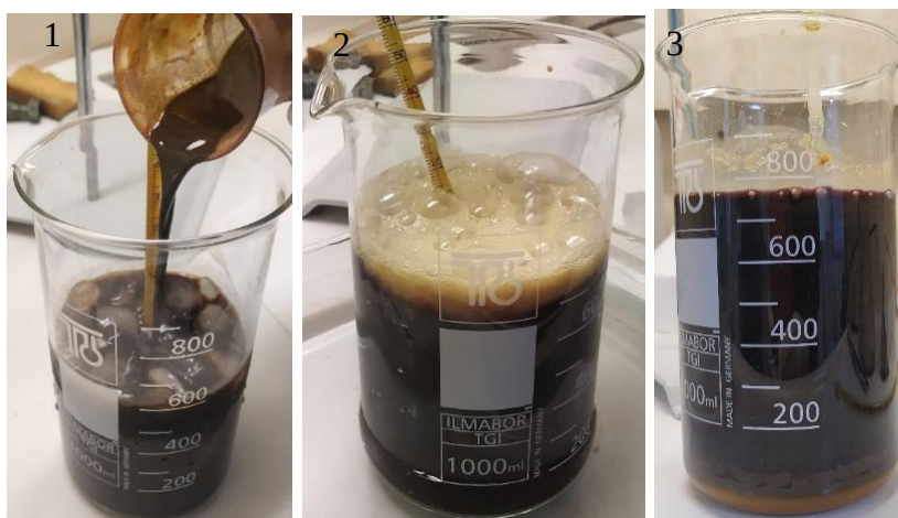
Εικόνα 30 : 1) Προσθήκη μίγματος με αργό ρυθμό στα παγάκια απιονισμένου νερού (σκούρο καφέ-κόκκινο χρώμα) 2) Αφρίζει το μίγμα μετά από την προσθήκη του υπεροξειδίου του υδρογόνου, παύση της οξειδωτικής αντίδρασης 3) Δημιουργήθηκε ίζημα του οξειδίου του γραφενίου, ανοιχτού καφέ χρώματος μετά από 3 μέρες. Το υπερκείμενο έχει έντονο μωβ χρώμα λόγω των ιόντων μαγγανίου.
