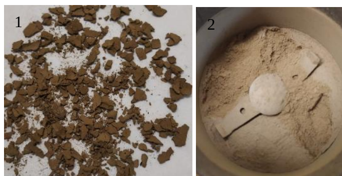
Εικόνα 33 : 1) Ξήρανση σε αντλία κενού 2) Άλεση μίγματος, σκόνη ανοιχτού καφέ χρώματος (10gr)
