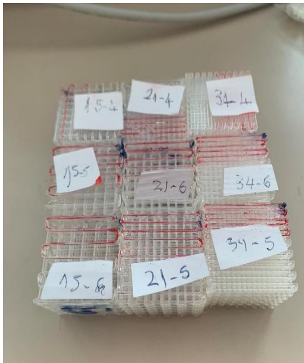
Εικόνα 15 Εκτυπωμένα δοκίμια σταθερών δομών από PLA με διαφορετικά πάχη δοκίδων.
