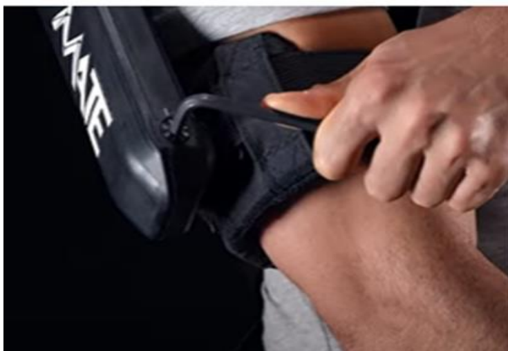
Σχήμα 1: Χειροκίνητη ρύθμιση του επιπέδου υποστήριξης του εξωσκελετού MATE-XT της COMAU.
