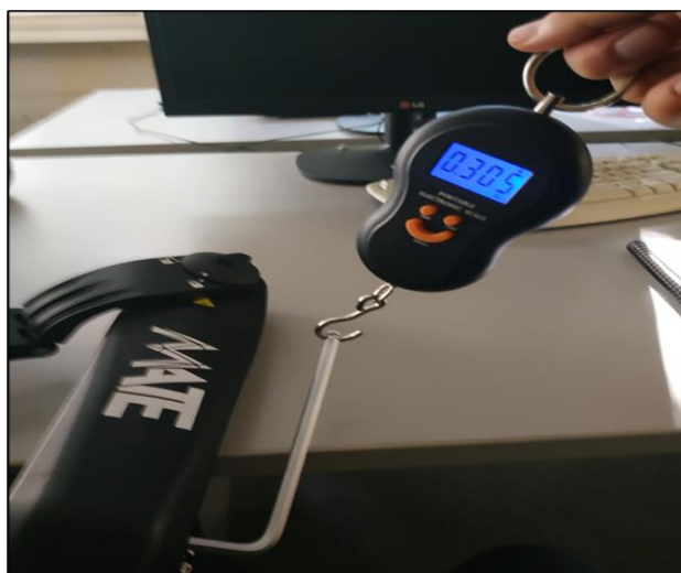
Σχήμα 3: Διαδικασία υπολογισμού της απαιτούμενης ροπής για κάθε βήμα.
