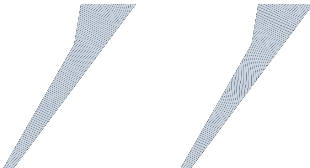
Σχήμα 8: Διαδρομές ινών για την άνω (αριστερά) και κάτω (δεξιά) επιδερμίδα της βέλτιστης δομής
