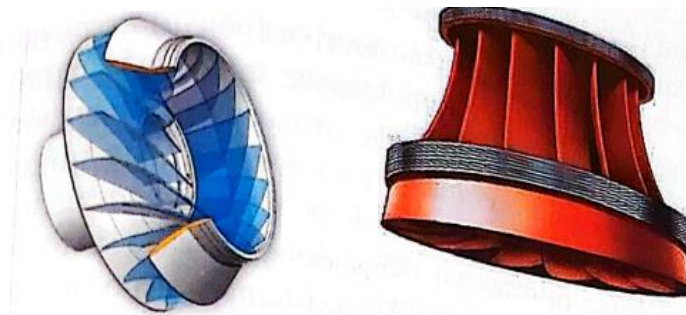
Εικόνα 43. Τα στροφεία του Υδροστροβίλου Francis. (Πηγή: Πολυζάκης, 2019)
