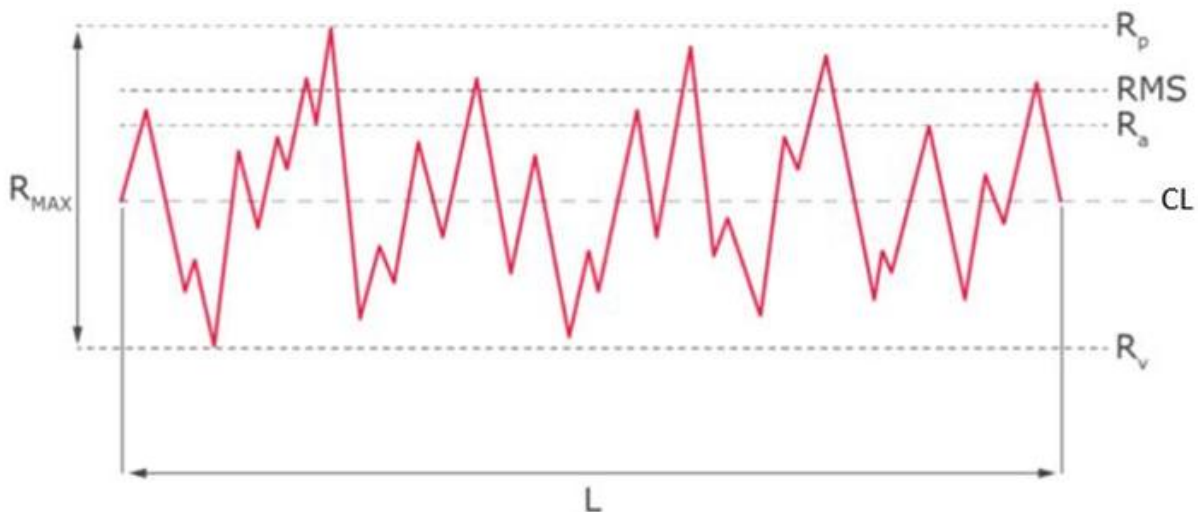
Εικόνα 17: Προφίλ επιφάνειας με μέση τραχύτητα, μέση τετραγωνική τιμή και βάθος κατανομής τραχύτητας [36]
